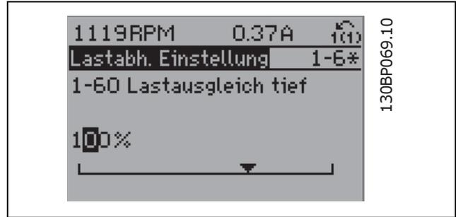
Mit den [^]-/[v]-Navigationstasten wird der Datenwert geändert. Stellen Sie den gewünschten Wert ein und drücken Sie [OK]. Der mögliche Bereich, der zur Datenänderung zur Verfügung steht, wird in dem unteren Balken grafisch dargestellt.
