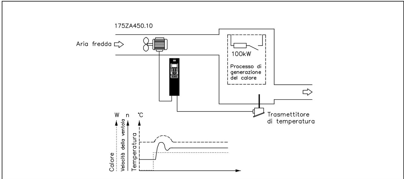
In un sistema di ventilazione, la temperatura deve essere regolabile da  $-5$  a  $-35^{\circ}\text{C}$  con un potenziometro da 0-10 Volt. La temperatura impostata deve essere mantenuta costante, utilizzando a tale scopo il controllo di processo.
