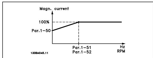
**1-51 Min velocità magnetizz. norm. [RPM]****Campo:**
