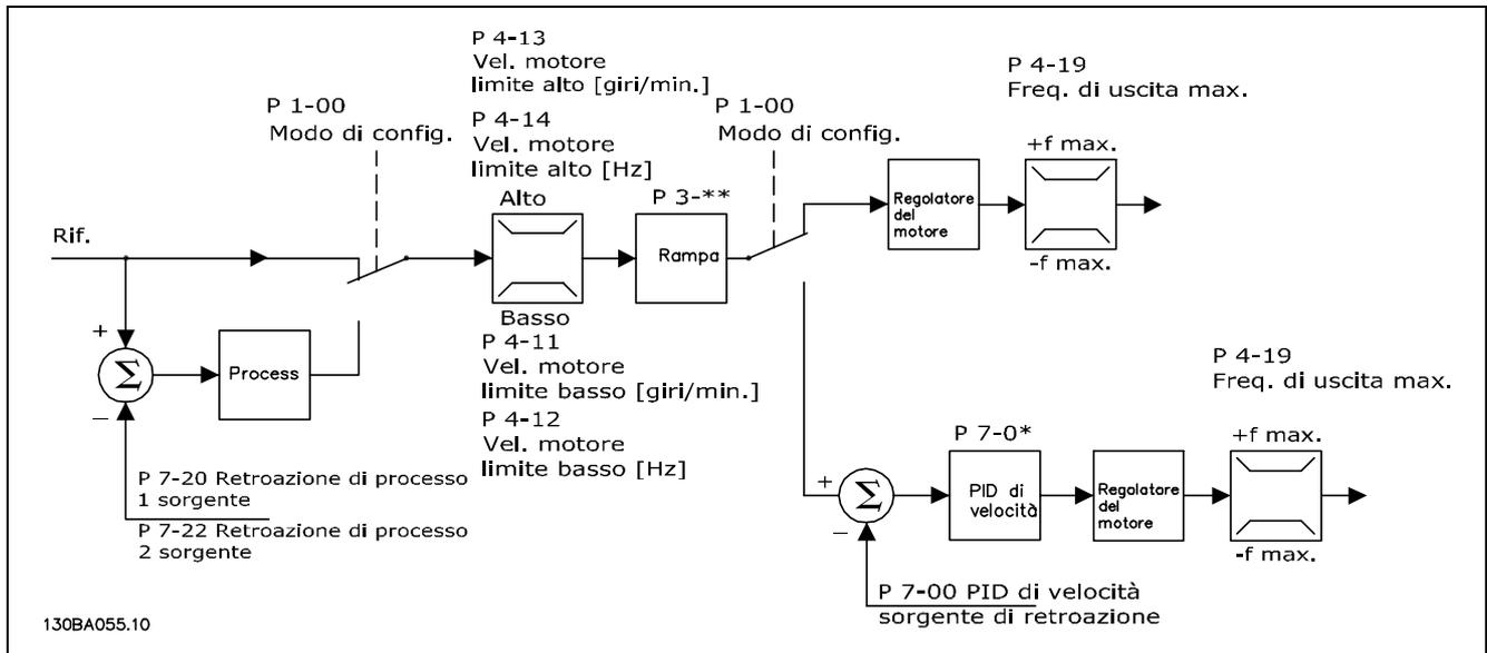
Nella configurazione mostrata nella figura precedente, il par. 1-01 *Principio Controllo Motore* è impostato su "VVC<sup>plus</sup> [1]" e il par. 1-00 è impostato su "Veloc. anello aperto [0]". Il segnale di riferimento risultante dal sistema di controllo del riferimento viene ricevuto e alimentato attraverso la limitazione di rampa e di velocità prima di essere inviato al controllo del motore. L'uscita del controllo del motore viene poi limitata dal limite di frequenza massima.
