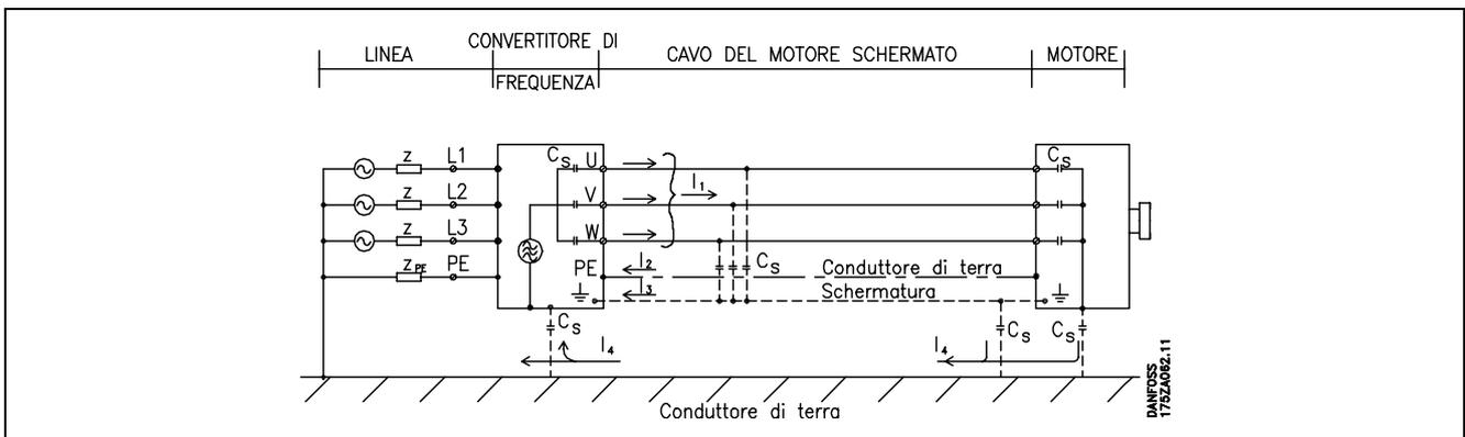
Se la schermatura deve essere posizionata su una piastra di installazione del convertitore di frequenza, tale piastra deve essere in metallo, in quanto le correnti di schermatura devono essere ricondotte all'unità. Inoltre è necessario assicurare un buon contatto elettrico dalla piastra di installazione per mezzo delle viti di montaggio e allo chassis del convertitore di frequenza.
