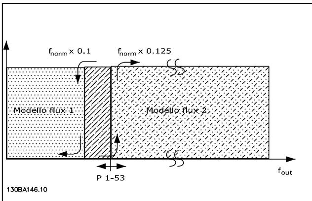
**Velocità anello chiuso o Coppia par. 1-00 = [1] o [2] e Flux con retr. motore par. 1-01 = [3]**
