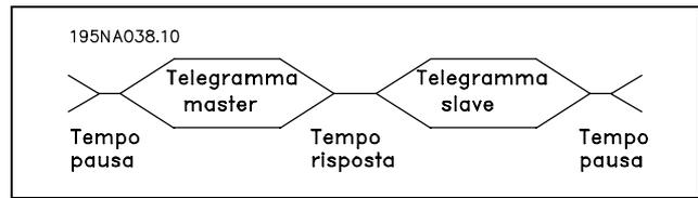
Dopo un telegramma di risposta dallo slave, assicurare che vi sia una pausa di almeno 2 caratteri (22 bit) prima che il master possa inviare un nuovo telegramma. Ad una baud rate di 9600 baud, assicurare che vi sia una pausa di almeno 2,3 ms. Dopo che il master ha completato il telegramma, il tempo di risposta dello slave al master durerà al massimo 20 ms, con una pausa di almeno 2 caratteri.
