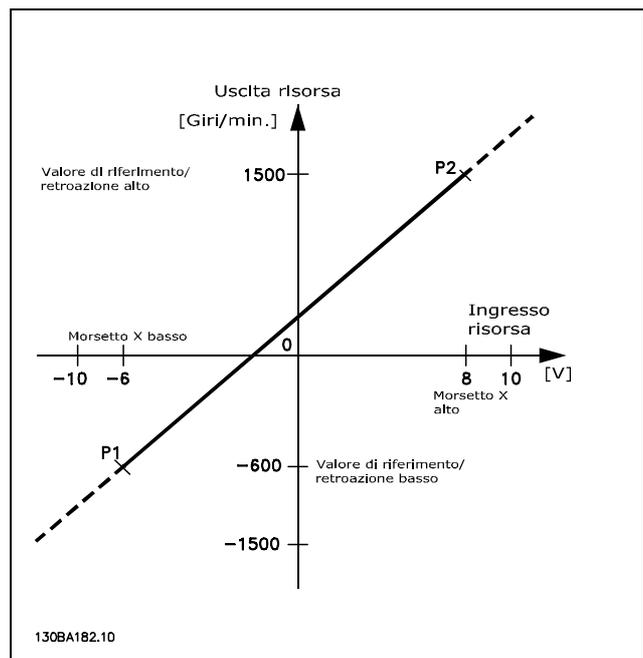
I punti finali P1 e P2 sono definiti dai seguenti parametri in funzione di quale ingresso analogico o digitale viene utilizzato
