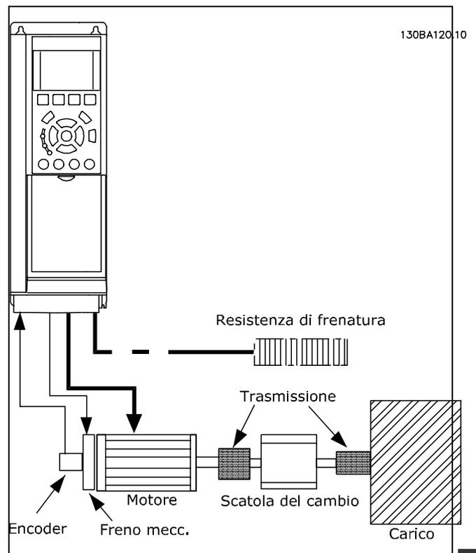
**Impostazione di base per la regolazione di velocità ad anello chiuso dell'FC 302**
