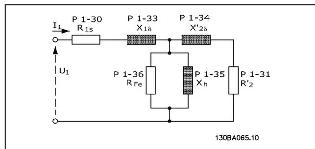
**Grafico equivalente di un motore asincrono**
