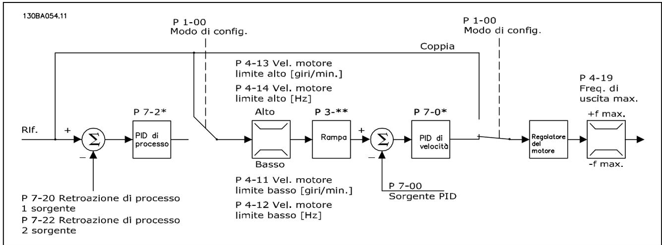
Nella configurazione mostrata, il par. 1-01 *Principio Controllo Motore* è impostato su "Flux c. retr. encoder [3]" e il par. 1-00 è impostato su "Velocità, anello chiuso [1]".
