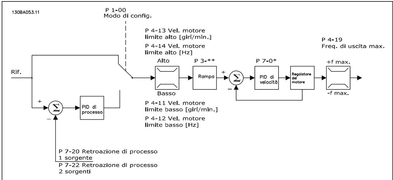
Nella configurazione mostrata, il par. 1-01 *Principio Controllo Motore* è impostato su "Flux sensorless [2]" e il par. 1-00 è impostato su "Veloc. anello aperto [0]". Il riferimento risultante dal sistema di gestione dei riferimenti è alimentato attraverso le limitazioni di rampa e di velocità come definito dalle impostazioni parametri indicate.
