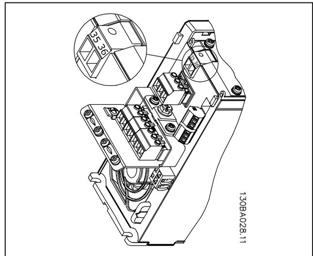
Collegamento all'alimentazione di back-up 24 V.
