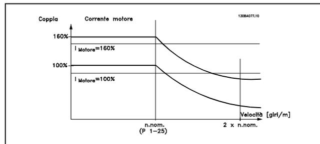
! Se si cambia il par. 4-16 *Lim. di coppia in modo motore* quando il par. 1-00 è impostato su *ANELLO APERTO VEL.* [0], il par. 1-66 *Corrente min. a bassa velocità* viene regolato automaticamente. Se il par. 2-21 > par. 2-36, sussiste un potenziale rischio di stallo del motore.
