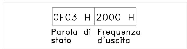
□ **Esempio 1: Per il controllo del convertitore di frequenza e la lettura dei parametri**
