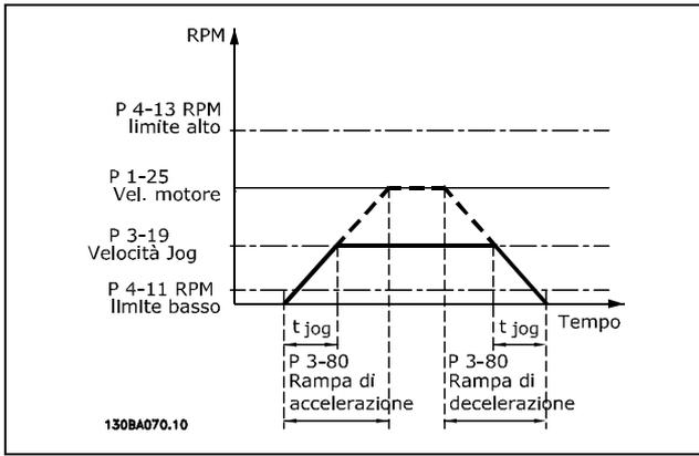
$$Par.3 - 80 = \frac{t_{jog} * n_{norm} [Par.1 - 25]}{\Delta jog Velocità [Par.3 - 19]} [sec]$$
