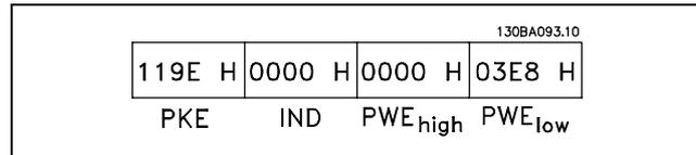
Esempio - Lettura di un valore parametrico:
