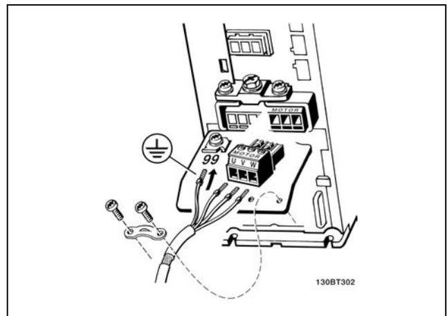
Tutti i tipi di motori standard asincroni trifase possono essere collegati all'FC 300. Di norma, i motori di dimensioni ridotte (230/400 V, D/Y) vengono collegati a stella. I motori di dimensioni maggiori vengono collegati a triangolo (400/690 V, D/Y). Per la modalità di collegamento e la tensione opportuna, fare riferimento alla targhetta del motore.
