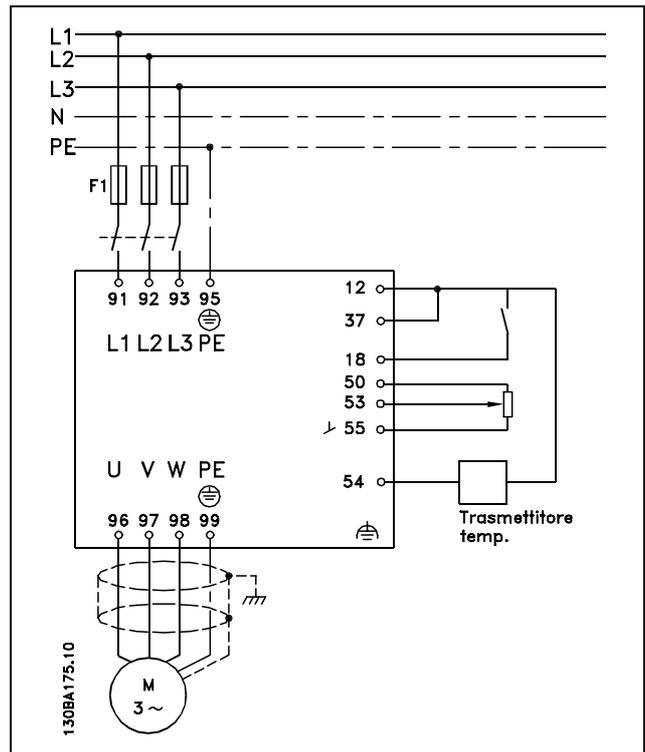
1. Avviamento/arresto tramite l'interruttore collegato al morsetto 18.
