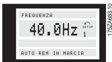
La riga 2 mostra la frequenza di uscita corrente e la Programmazione attiva. La riga 4 indica che il convertitore di frequenza è in modo Auto con riferimento remoto e che il motore è in funzione.
