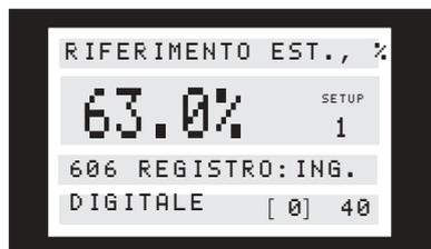
Per visualizzare i registri dati [1] - [20], premere prima [CHANGE DATA], quindi i tasti [+/-] per scorrere i numeri del registro. È inoltre possibile visualizzare i parametri 606-614 Log dati mediante la porta di comunicazione seriale.
