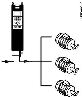
VLT 6000 HVAC-Frequenzumrichter können mehrere parallelgeschaltete Motoren steuern. Wenn die Motoren verschiedene Drehzahlen haben sollen, dann müssen Motoren mit unterschiedlichen Nenndrehzahlen eingesetzt werden. Da sich die Drehzahlen der Motoren gleichzeitig ändern, bleibt das Verhältnis zwischen den Nenndrehzahlen über den gesamten Bereich hinweg erhalten. Die Gesamtstromaufnahme der Motoren darf den maximalen Nenn-Ausgangsstrom  $I_{VLT,N}$  des Frequenzumrichters nicht übersteigen.
