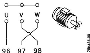
Aus der Werkseinstellung ergibt sich eine Rechtsdrehung, wenn der Ausgang des Frequenzumrichters wie folgt angeschlossen wurde:
