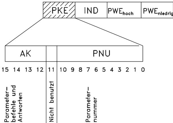
Parameterbefehle und Antworten (AK) Die Bits Nr. 12-15 werden zur Übertragung der Parameterbefehle vom Master an den Slave und der vom Slave bearbeiteten Rückantwort an den Master benutzt.
