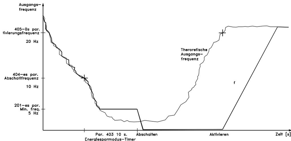
Während der Frequenzumrichter den Motor gestoppt und in den Energiesparzustand versetzt wurde, wird eine theoretische Ausgangsfrequenz auf Basis des Sollwertsignals berechnet. Wenn die theoretische Ausgangsfrequenz über die in Parameter 405, *Energie Start-F.*, festgelegte Frequenz steigt, startet der Frequenzumrichter den Motor neu, und die Ausgangsfrequenz wird auf den Sollwert erhöht.
