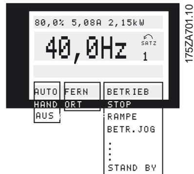
Im linken Teil der Zustandszeile wird das aktive Steuerelement des Frequenzumrichters angezeigt. AUTO bedeutet, dass die Steuerung über die Steuerklemmen erfolgt; HAND bedeutet, dass die Steuerung über die Bedientastentasten erfolgt.
