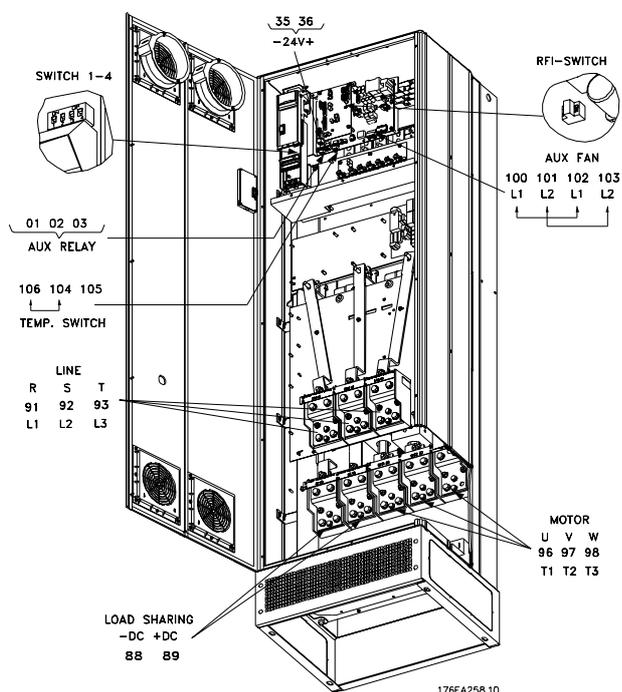
**Compact IP21/IP54 sans sectionneur ni fusible
