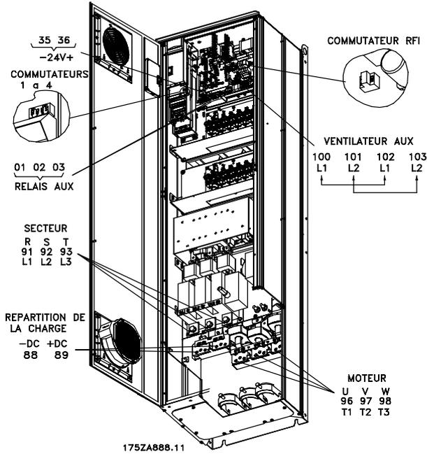
**IP54, IP21/NEMA 1 avec sectionneur et fusible secteur**
