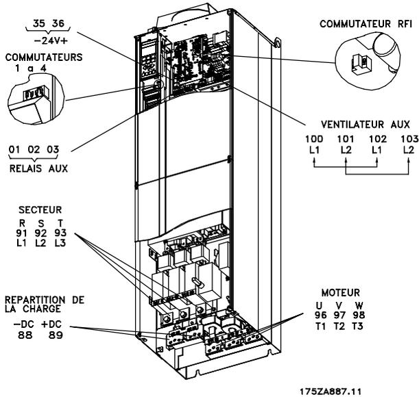
**IP00 avec sectionneur et fusible**
