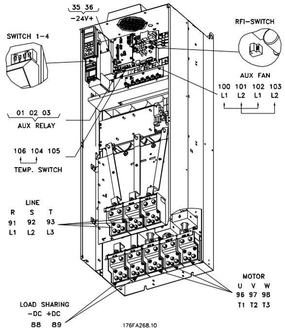
**Compact IP00 sans sectionneur ni fusible**
