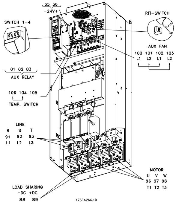
**Compact IP00 avec sectionneur et fusible**
