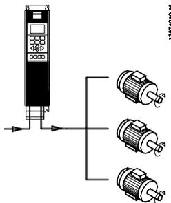
Le VLT 6000 HVAC peut commander plusieurs moteurs montés en parallèle. Si les vitesses des moteurs doivent être différentes, il est nécessaire d'installer des moteurs de vitesse nominale différente. Les vitesses des moteurs varient simultanément et le rapport entre les vitesses nominales est maintenu sur toute la plage. La valeur du courant total consommé par les moteurs ne doit pas dépasser la valeur maximale du courant de sortie nominal  $I_{VLT,N}$  du variateur de vitesse.
