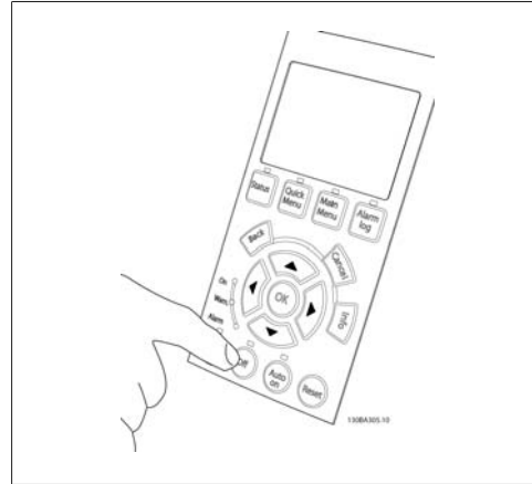
Illustration 4.26: ขั้นที่ 8: กดปุ่ม [OFF] เพื่อหยุดมอเตอร์อีกครั้ง
