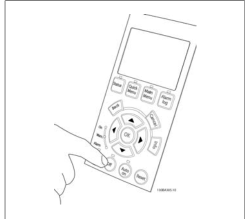
Illustration 4.26: ステップ 8: [Off] ボタンを押して、モーターをもう一度停止します。
