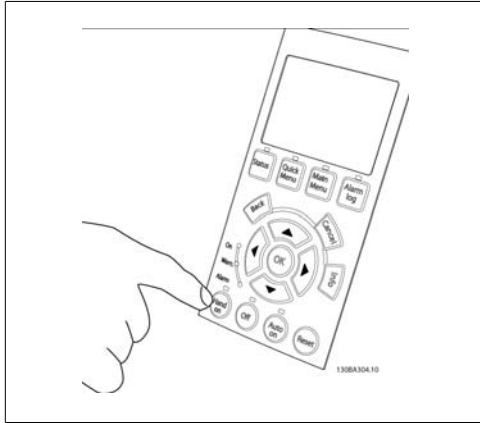
Illustration 4.23: ステップ 5: [Hand on] ボタンを押して、ボタンの上側にある LED が点灯して、モーターが回転することを確認します。
