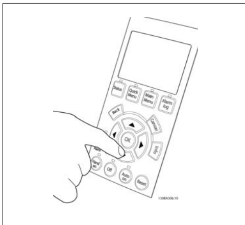
Illustration 4.25: ステップ 7: カーソルを移動するには、左向き矢印 ◀ と右向き矢印 ▶ ボタンを使用します。これによって、速度を大きく変更させることができます。
