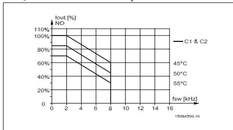
Illustration 8.8: Снижение тока  $I_{out}$  для различных значений  $T_{AMB, MAX}$  в случае корпуса С при использовании модели коммутации SFAVM в режиме нормального крутящего момента (перегрузка по крутящему моменту 110 %).
