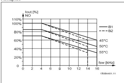
Illustration 8.5: Снижение тока  $I_{out}$  для различных значений  $T_{AMB, MAX}$  в случае корпуса В при использовании модели коммутации 60 PWM в режиме нормального крутящего момента (перегрузка по крутящему моменту 110 %).
