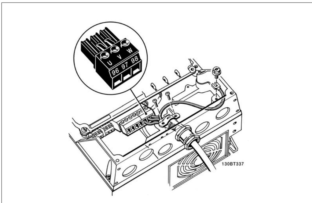
Illustration 4.13: Сначала подсоедините заземляющий провод двигателя, затем присоедините провода двигателя U, V и W к клеммной колодке и затяните клеммы. Убедитесь, что наружная изоляция кабеля под зажимом ЭМС удалена.
