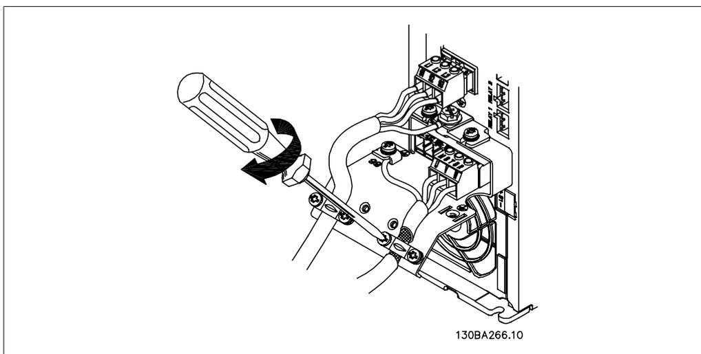
Illustration 4.12: Установите кабельный зажим, чтобы обеспечить 360-градусное соединение экранирующей оплетки кабеля с шасси по всей окружности. Убедитесь, что наружная изоляция кабеля под зажимом снята.
