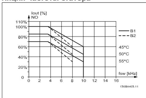
Illustration 8.6: Снижение тока  $I_{out}$  для различных значений  $T_{AMB, MAX}$  в случае корпуса В при использовании модели коммутации SFAVM в режиме нормального крутящего момента (перегрузка по крутящему моменту 110 %).
