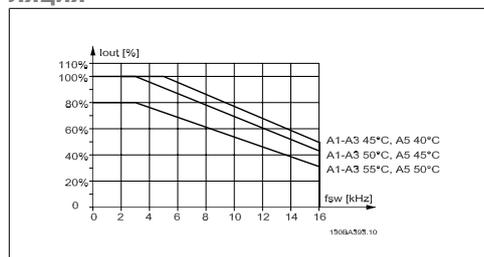
Illustration 8.1: Снижение тока  $I_{out}$  для различных значений  $T_{AMB, MAX}$  при использовании корпуса A и модели коммутации 60 PWM
