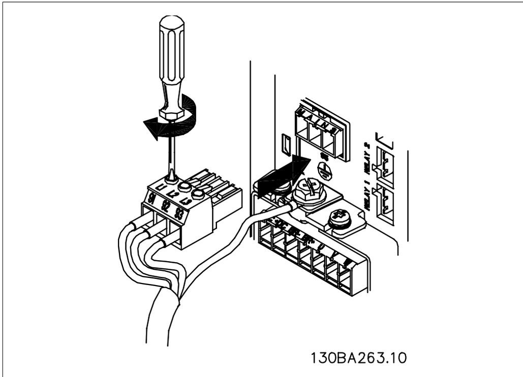
Illustration 4.4: Присоедините провода к сетевому разъему и затяните клеммы.
