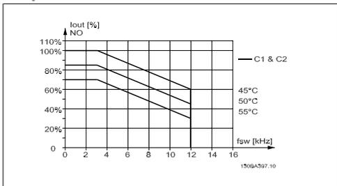
Illustration 8.7: Снижение тока  $I_{out}$  для различных значений  $T_{AMB, MAX}$  в случае корпуса С при использовании модели коммутации 60 PWM в режиме нормального крутящего момента (перегрузка по крутящему моменту 110 %).
