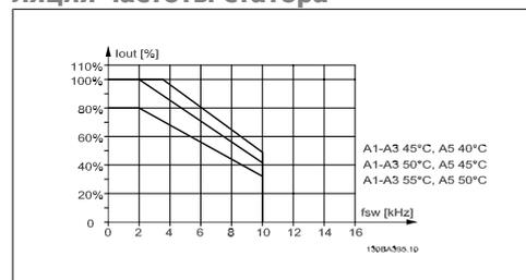
Illustration 8.2: Снижение тока  $I_{out}$  для различных значений  $T_{AMB, MAX}$  в случае корпуса A при использовании модели коммутации 60 SFAVM
