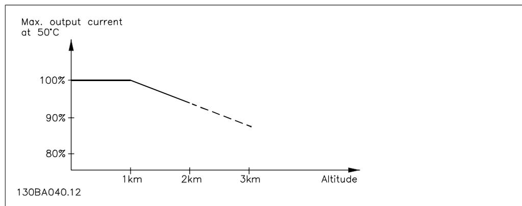
Illustration 8.9: Снижение выходного тока в зависимости от высоты над уровнем моря при температуре окружающей среды  $T_{AMB, MAX}$ . Если высота над уровнем моря превышает 2 км, обратитесь в компанию Danfoss Drives относительно требований PELV.
