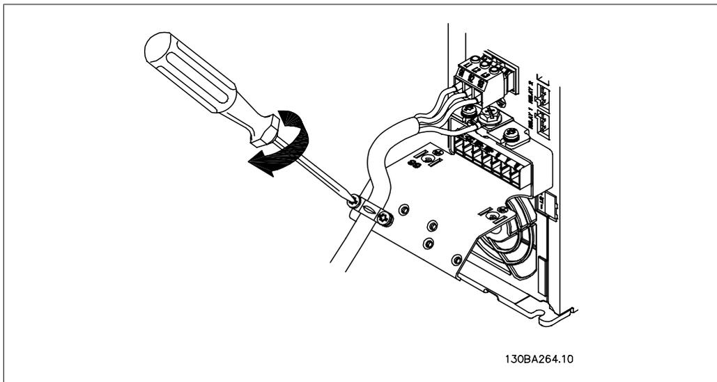
Illustration 4.5: Закрепите сетевой кабель при помощи кабельного зажима.
