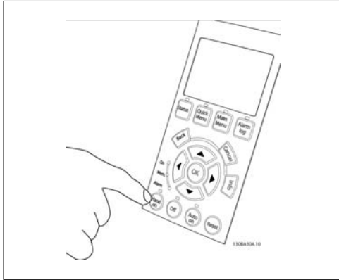
Ilustración 4.23: Paso 5: Al pulsar el botón [Hand on] (Marcha local), el LED situado encima del botón debería encenderse y el motor debería girar.
