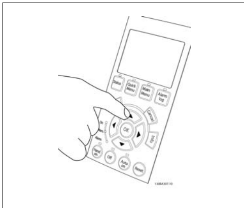
Ilustración 4.24: Paso 6: En el LCP se puede ver la velocidad del motor. Se puede ajustar pulsando los botones flecha arriba ▲ y flecha abajo ▼.
