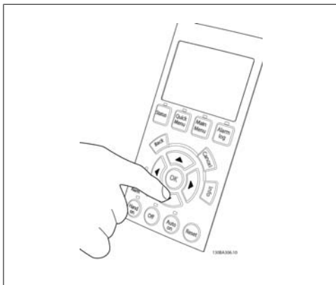
Ilustración 4.25: Paso 7: Para mover el cursor, utilice los botones flecha izquierda ◀ y flecha derecha ▶. Esto le permitirá cambiar la velocidad en incrementos mayores.
