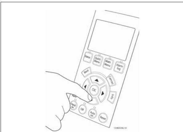
Ilustração 4.45: Passo 7: Para mover o cursor, utilize os botões esquerdo ◀ e direito ▶. Isto permite alterar a velocidade com incrementos maiores.
