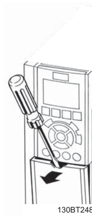
Ilustração 4.46: Acesso aos terminais de controle dos gabinetes metálicos A2, A3, B3, B4, C3 e C4
