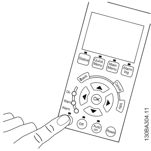
그림 4.41: 5단계: [Hand on] 버튼을 누르면 버튼 위에 있는 LED가 켜지며 모터가 회전할 수 있습니다.
