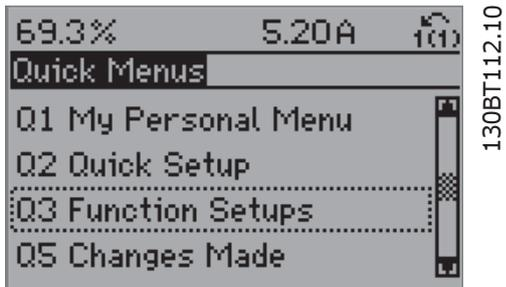
図 6.4: ステップ 3: ナビゲーション・キーの上下キーで [機能設定] までスクロールします。[OK] を押します。
