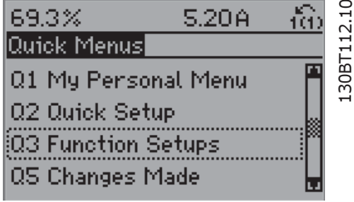
Çizim 6.4: Adım 3: İşlev kurulumları seçeneğine ilerlemek için yukarı/aşağı gezinme tuşlarını kullanın. [OK] tuşuna basın.
