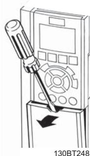
図 4.38: A2、A3、B3、B4、C3、C4 エンクロージャコントロール端子にアクセス
