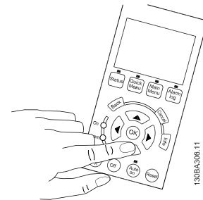
圖 4.47: 步驟 7: 要移動游標，請使用向左 ◀ 與向右 ▶ 箭頭按鈕。這將使轉速以較大幅度變動。
