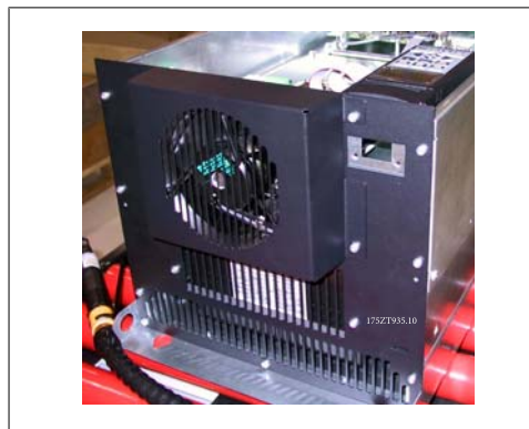
Ilustracja 3.35: Górna część przetwornicy częstotliwości IP 00 / Chassis
