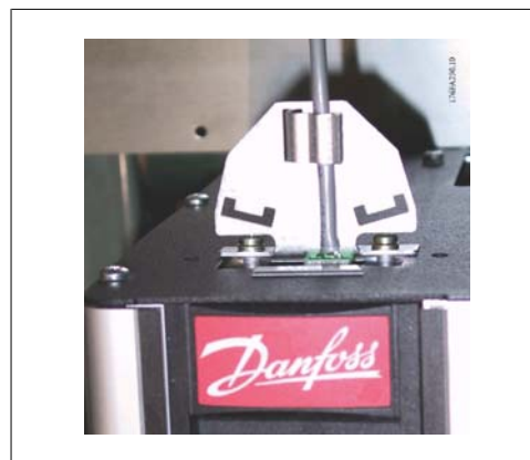
Ilustracja 3.69: Podłączenie magistrali komunikacyjnej w górnej części urządzenia.
