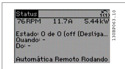
A **Seção Inferior** sempre indica o estado do conversor de frequência, no modo Status.
