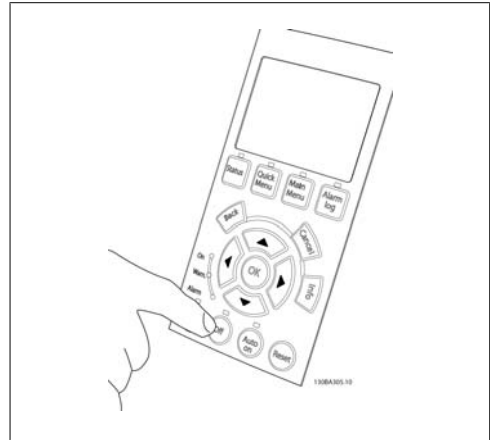
그림 5.26: 8단계: 다시 모터를 정지하려면 [Off] 버튼을 누르십시오.
