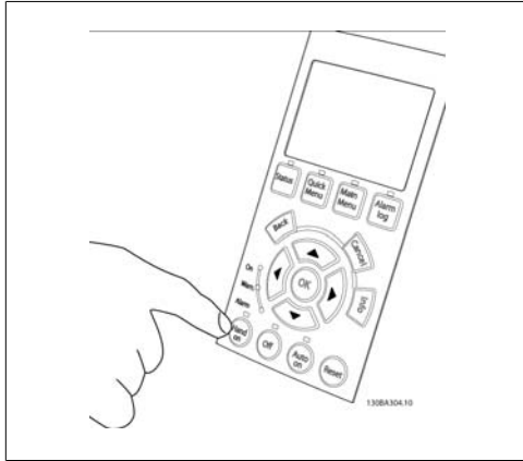
그림 5.23: 5단계: [Hand on] 버튼을 누르면 버튼 위에 있는 LED가 켜지며 모터가 회전할 수 있습니다.
