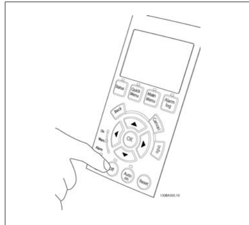
圖 5.26: 步驟 8: 按下 [Off] 按鈕可再度停止馬達。
