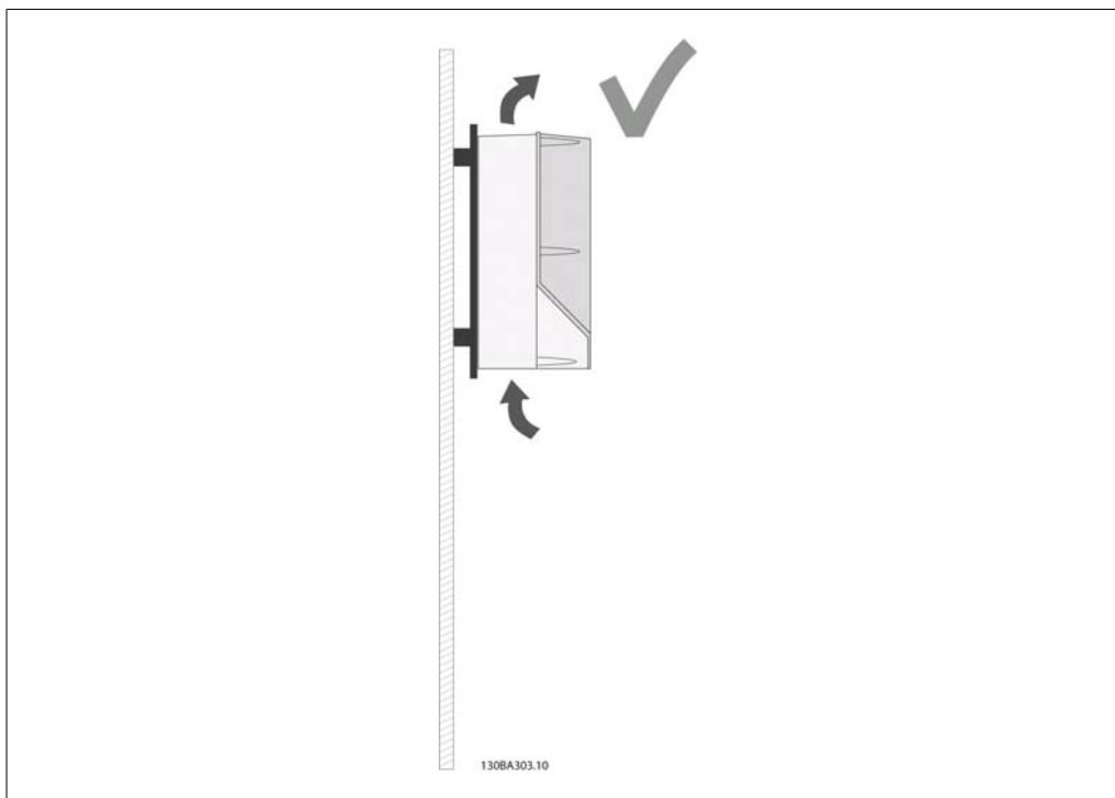
Ábra 4.4: Ha a készüléket nem lehet közvetlenül a falra szerelni, rendeljen hozzá hátlapot (lásd: Rendelési típuskód, 14–15. hely). Az A2 és A3 készüléket alapkiépítésben hátlappal szállítjuk.
