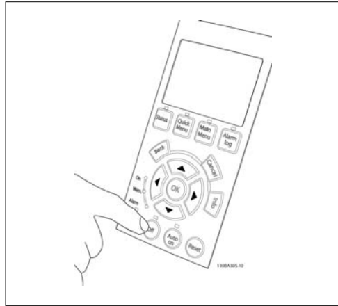
ภาพประกอบ 5.26: ขั้นที่ 8: กดปุ่ม [Off] เพื่อหยุดมอเตอร์อีกครั้ง
