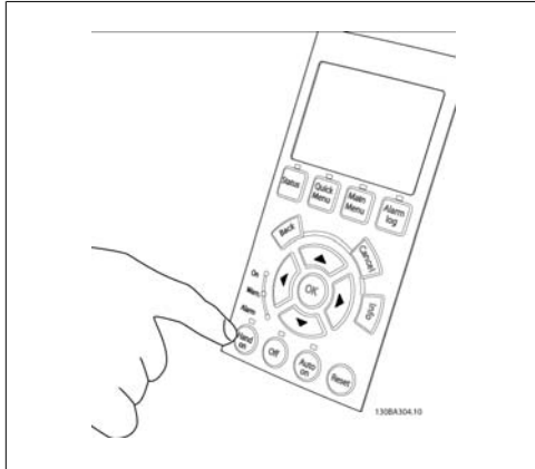
ภาพประกอบ 5.23: ขั้นที่ 5: โดยการกดปุ่ม [Hand on] LED ที่อยู่เหนือปุ่ม ควรจะติดและมอเตอร์อาจจะหมุน
