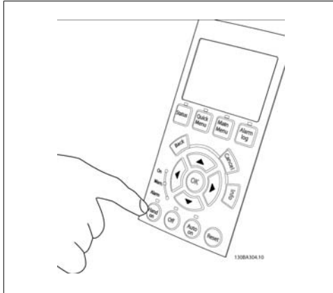
Ilustrasi 5.23: Langkah 5: Dengan menekan tombol [Hand on], LED di atas tombol harus menyala dan motor boleh berputar sekarang.
