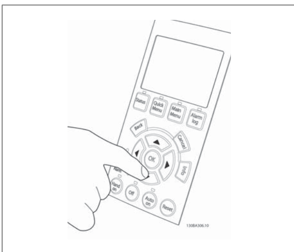
Bild 5.27: Använd pilknapparna vänster ◀ och höger ▶ för att flytta markören. Detta gör att varvtalet kan ändras i större steg.
