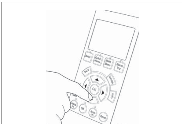
Illustration 5.52: Étape 7 : pour déplacer le curseur, utiliser les touches fléchées gauche ◀ et droite ▶. Cela permet de changer la vitesse par de grands incréments.
