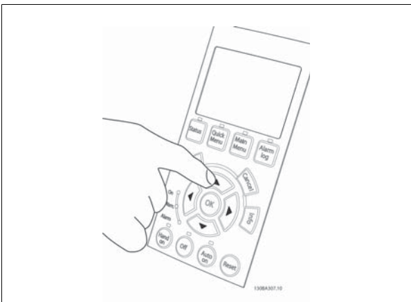
Illustration 5.51: Étape 6 : la vitesse du moteur s'affiche sur le LCP. Elle peut être ajustée en appuyant sur les touches fléchées haut ▲ et bas ▼.
