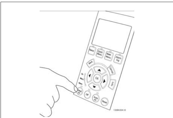
Illustration 5.50: Étape 5 : d'une pression sur la touche [Hand on], le voyant au-dessus de la touche doit s'allumer et le moteur peut tourner.
