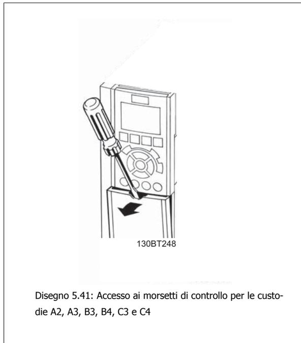
Rimuovere il coperchio anteriore per accedere ai morsetti di controllo. Durante la sostituzione del coperchio anteriore assicurare il corretto serraggio a una coppia di 2 Nm.
