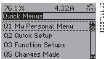
Ábra 8.3: 2. lépés: Nyomja meg a [Quick Menu] gombot (megjelenik a Gyorsmenük listája)
