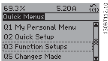
Ilustracja 8.4: Krok 3: Za pomocą przycisków nawigacji góra/dół przeglądać zestawy parametrów funkcji. Naciśnięcie przycisku [OK].
