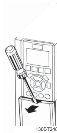
图 5.37: 访问 A2、A3、B3、B4、C3 和 C4 机箱的控制端子
