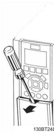
Ilustrasi 5.37: Jalan masuk penutup A2, A3, B3, B4, C3 dan C4 ke terminal kontrol
