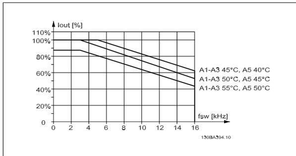
图 3.3:  $I_{out}$  在不同  $T_{AMB, MAX}$  下的降容 – A 型机箱，开关模式为 60 AVM，电动机电缆的最大长度不超过 10 m
