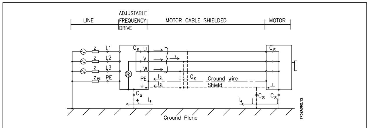
如果要将屏蔽丝网放在变频器的固定板上，该固定板必须由金属制成，因为屏蔽丝网电流必须被带回设备。另外，还应确保从固定板到固定螺钉以及变频器机架都有良好的电气接触。
