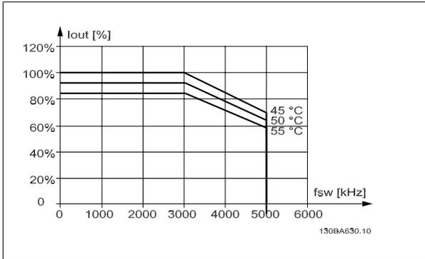
图 3.13: 600 V 时,  $I_{out}$  在不同  $T_{AMB, MAX}$  下的降容 - D 型机箱, 在正常转矩模式 (110% 过转矩) 下使用 60 AVM。注意: 仅限 P315。
