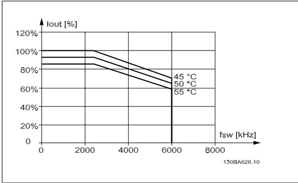
图 3.11: 600 V 时,  $I_{out}$  在不同  $T_{AMB, MAX}$  下的降容 - D 型机箱, 在正常转矩模式 (110% 过转矩) 下使用 60 AVM。注意: 对 P315 无效。
