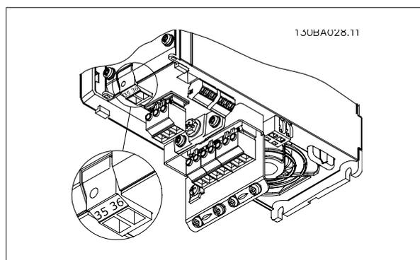
图 3.21: 24 V 备用电源的连接 (A2-A3)。
