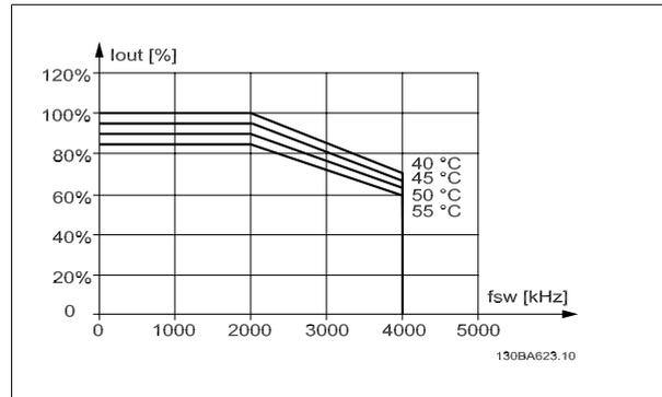
图 3.16: 480 V 时,  $I_{out}$  在不同  $T_{AMB, MAX}$  下的降容 - E 型机箱, 在正常转矩模式 (110% 过转矩) 下使用 SFAVM
