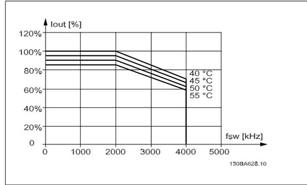
图 3.12: 600 V 时,  $I_{out}$  在不同  $T_{AMB, MAX}$  下的降容 - D 型机箱, 在正常转矩模式 (110% 过转矩) 下使用 SFAVM。注意: 对 P315 无效。
