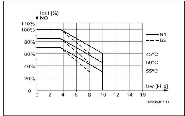
图 3.6:  $I_{out}$  在不同  $T_{AMB, MAX}$  下的降容 - B 型机箱, 在正常转矩模式 (110% 过转矩) 下使用 SFAVM
