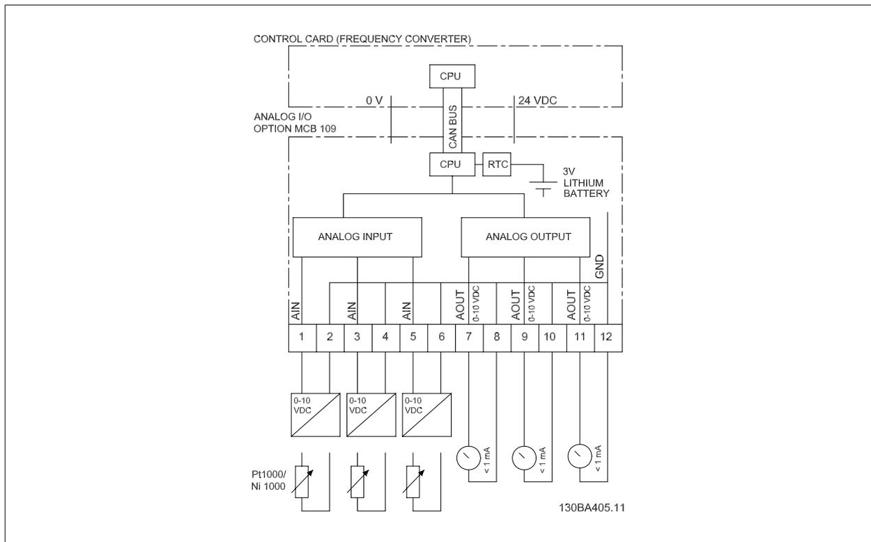
图 3.23: 安装在变频器中的模拟输入输出的原理图。
