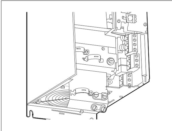
图 5.12: 机箱 B3 的直流总线连接。
