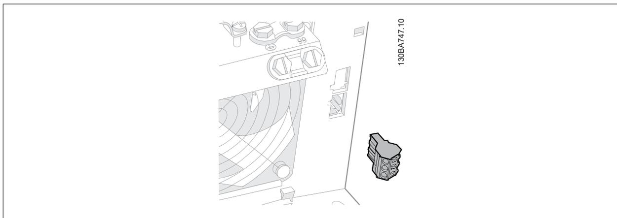
图 5.21: B3 的继电器连接端子。出厂时只由一个挡板。
