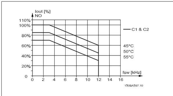
图 3.7:  $I_{out}$  在不同  $T_{AMB, MAX}$  下的降容 - C 型机箱, 在正常转矩模式 (110% 过转矩) 下使用 60 AVM
