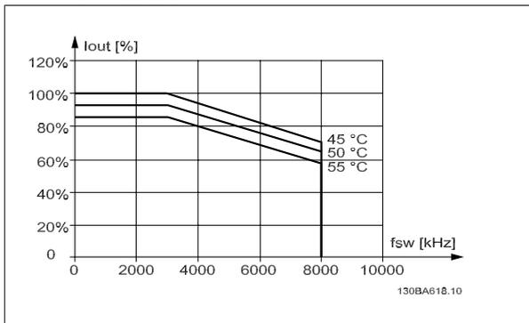
图 3.9: 480 V 时,  $I_{out}$  在不同  $T_{AMB, MAX}$  下的降容 - D 型机箱, 在正常转矩模式 (110% 过转矩) 下使用 60 AVM
