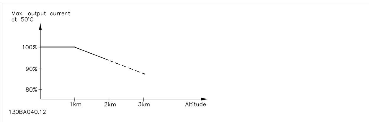
图 3.19: 在  $T_{AMB, MAX}$  下, 输出电流降容与海拔的关系。当海拔超过 2 km 时, 请向 Danfoss 咨询 PELV 事宜。
