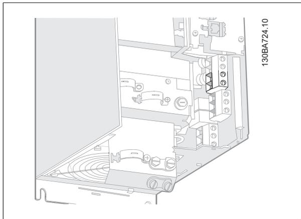
图 5.16: B3 的制动连接端子。
