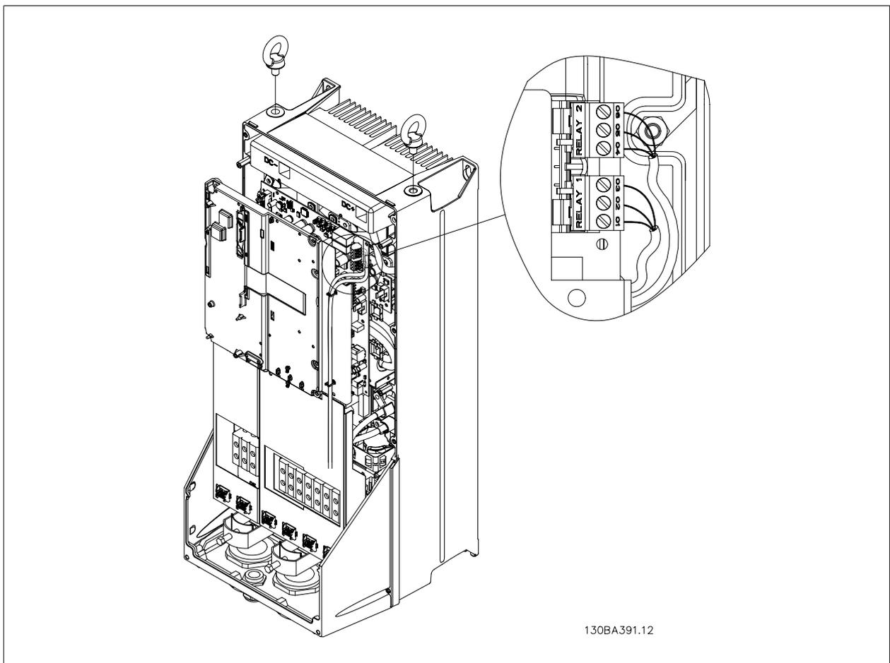
图 5.20: 继电器连接端子 (C1 和 C2 机箱)
