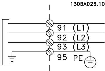
图 5.1: 主电源端子和接地端子。
