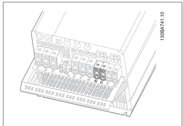
图 5.15: 机箱 C4 的直流总线连接。
