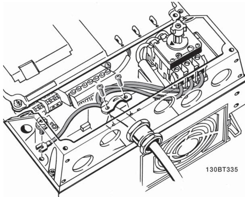
图 5.2: 如何使用断路器连接主电源和接地 (A5 机箱)。
