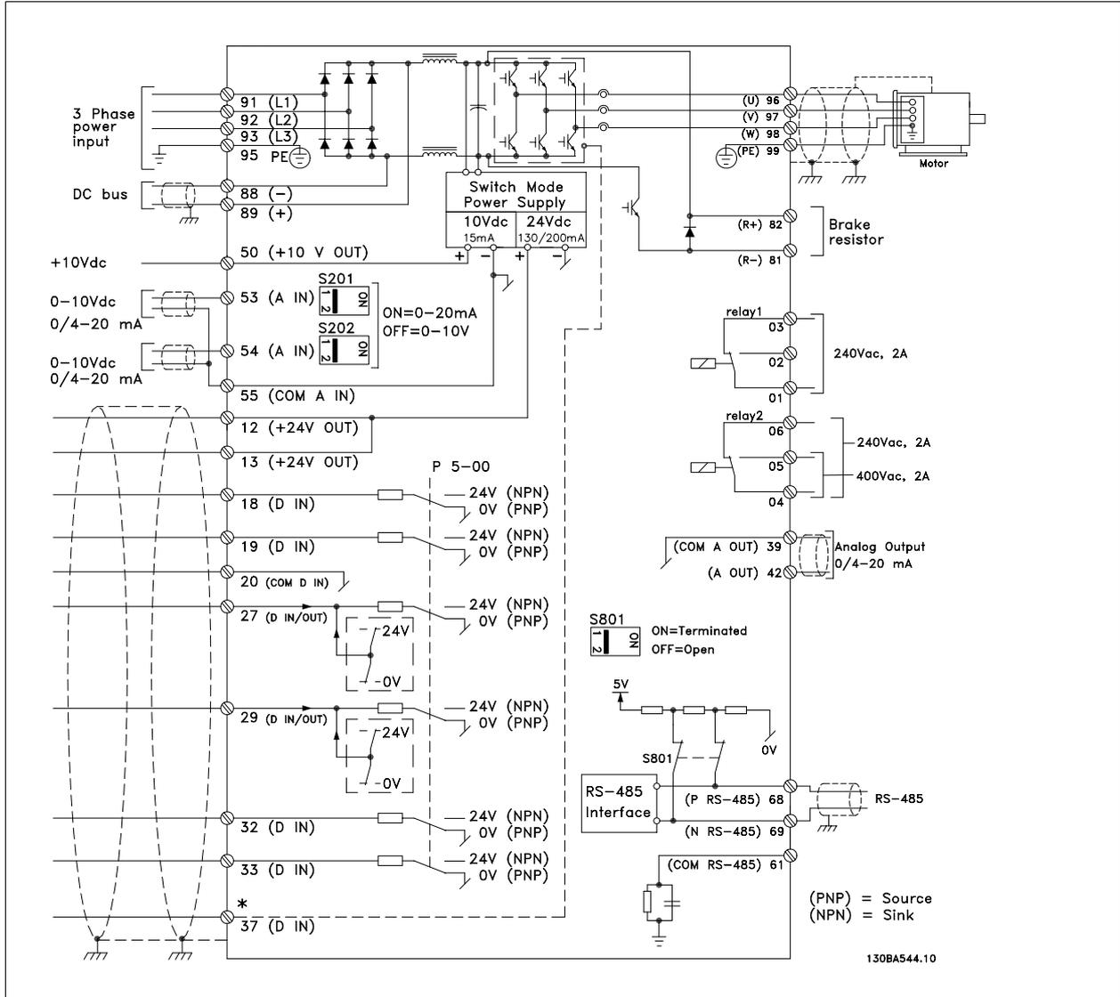
图 5.9: 端子 37: 安全停止输入仅随安全停止功能一起提供!
