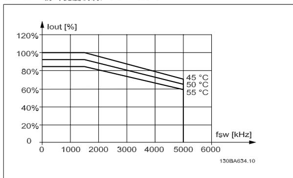
图 3.17: 600 V 时,  $I_{out}$  在不同  $T_{AMB, MAX}$  下的降容 - E 型机箱, 在正常转矩模式 (110% 过转矩) 下使用 60 AVM。
