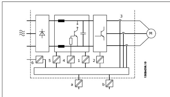
图 2.4: 高低压绝缘
