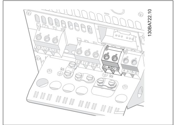
图 5.13: 机箱 B4 的直流总线连接。
