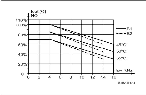
图 3.5:  $I_{out}$  在不同  $T_{AMB, MAX}$  下的降容 - B 型机箱, 在正常转矩模式 (110% 过转矩) 下使用 60 AVM
