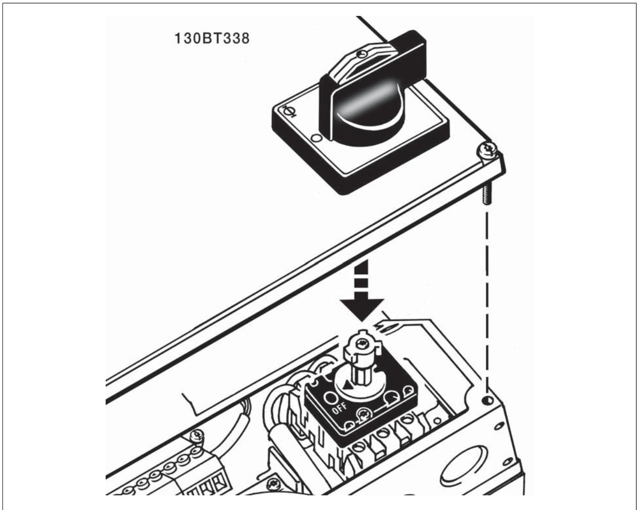
图 5.7: 装配带有主电源断路器的 IP21 / IP55 / NEMA TYPE 12 机箱。
