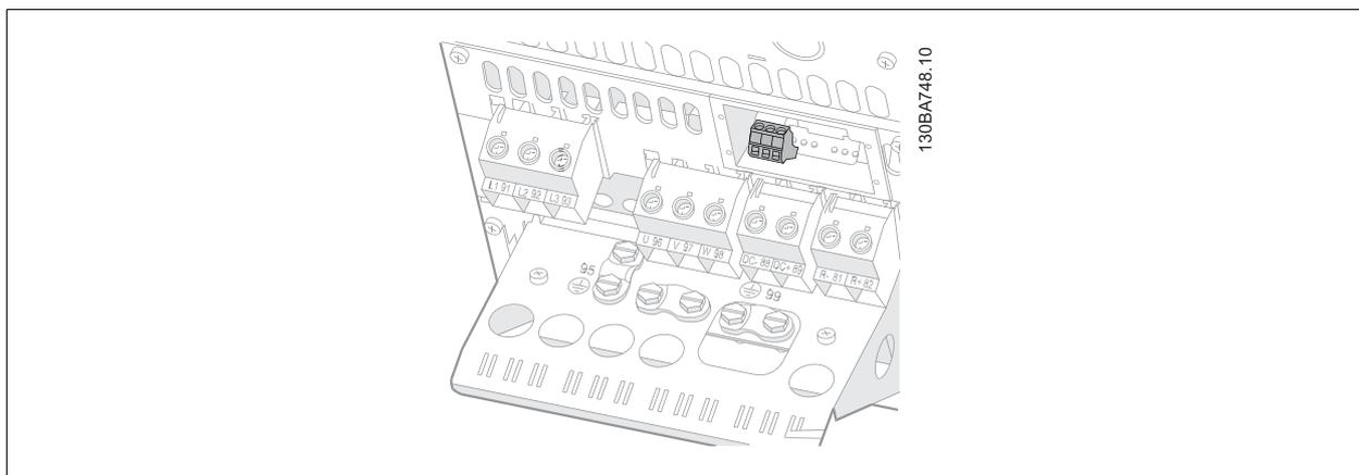
图 5.22: B4 的继电器连接端子。
