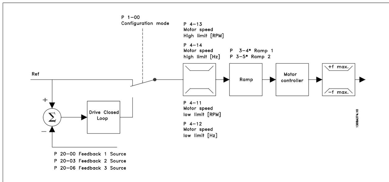
在上图所示的配置中，参数 1-00 被设为开环 [0]。在收到了参考值处理系统的最终参考值后，首先会对最终参考值进行加减速限制和速度限制，然后将它发送给电动机控制。之后，电动机控制的输出便会受到频率上限的限制。
