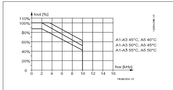
图 3.4:  $I_{out}$  在不同  $T_{AMB, MAX}$  下的降容 – A 型机箱，开关模式为 SFAVM，电动机电缆的最大长度不超过 10 m
