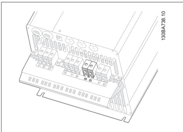
图 5.14: 机箱 C3 的直流总线连接。
