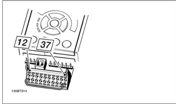
图 5.10: 端子 37 和 24 V 直流之间的桥接器 (跳线)。
