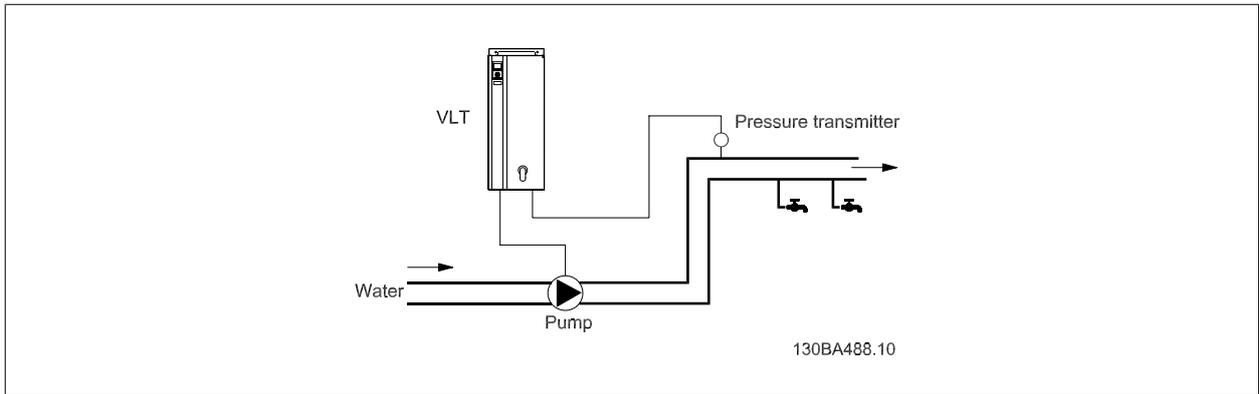
在配水系统中，压力需要维持在某个恒定水平。使用一个 0 - 10 V 的电位计将目标压力（给定值）设在 0 到 10 Bar 之间，也可通过参数进行设置。压力传感器的范围为 0 到 10 Bar，它使用二线传感器来提供 4 - 20 mA 信号。变频器的输出频率范围为 10 到 50 Hz。
