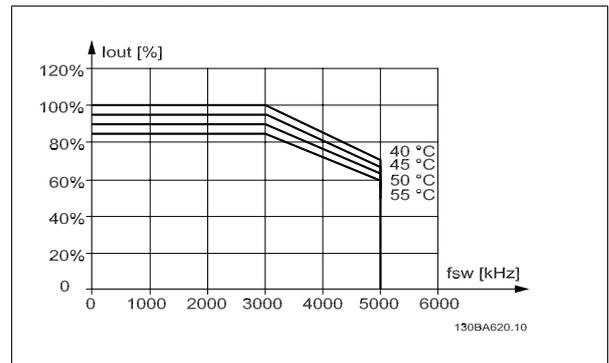
图 3.10: 480 V 时,  $I_{out}$  在不同  $T_{AMB, MAX}$  下的降容 - D 型机箱, 在正常转矩模式 (110% 过转矩) 下使用 SFAVM
