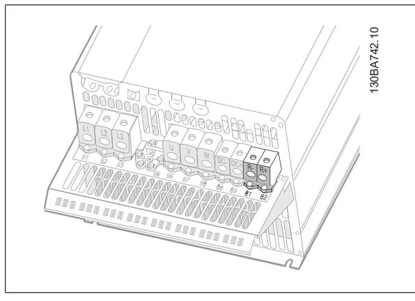
图 5.19: C4 的制动连接端子。
