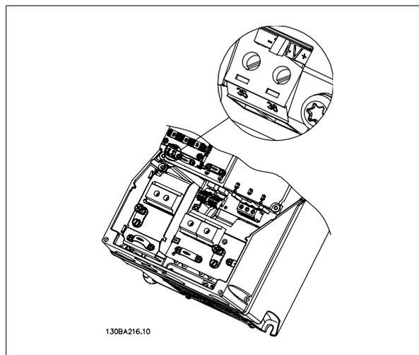
图 3.22: 24 V 备用电源的连接 (A5-C2)。
