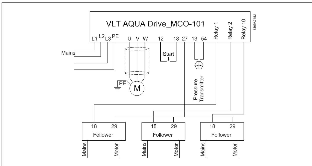
图 6.3: 电气连线。主变频器上的端子 27 用作脉冲输出参照值。从变频器上的端子 29 用作脉冲输入参照值。所有从变频器都与主变频器以相同方式连接主电源和电动机，并使用下列文本进行标记：*主电源和电动机*。
