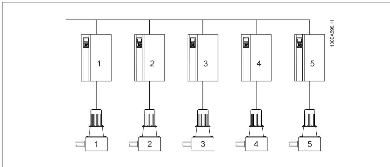
扩展型多泵控制器是一个可以添加到 VLT AQUA 变频器上的选配组件（包括硬件和软件）。它由安装在变频器 B 选件插槽中的选件板构成，其中包括 3 个继电器。一旦安装了该选件，便可以通过控制面板在参数组 27-\*\* 中配置用来支持扩展型多泵控制器功能的参数。与基本型多泵控制器相比，扩展型多泵控制器提供了更丰富的功能。可以用它的 3 个继电器来对基本多泵配置进行扩展。
