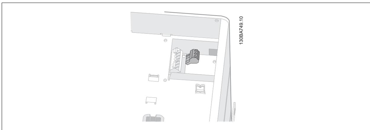
图 5.23: C3 和 C4 的继电器连接端子。位于变频器的右上角。
