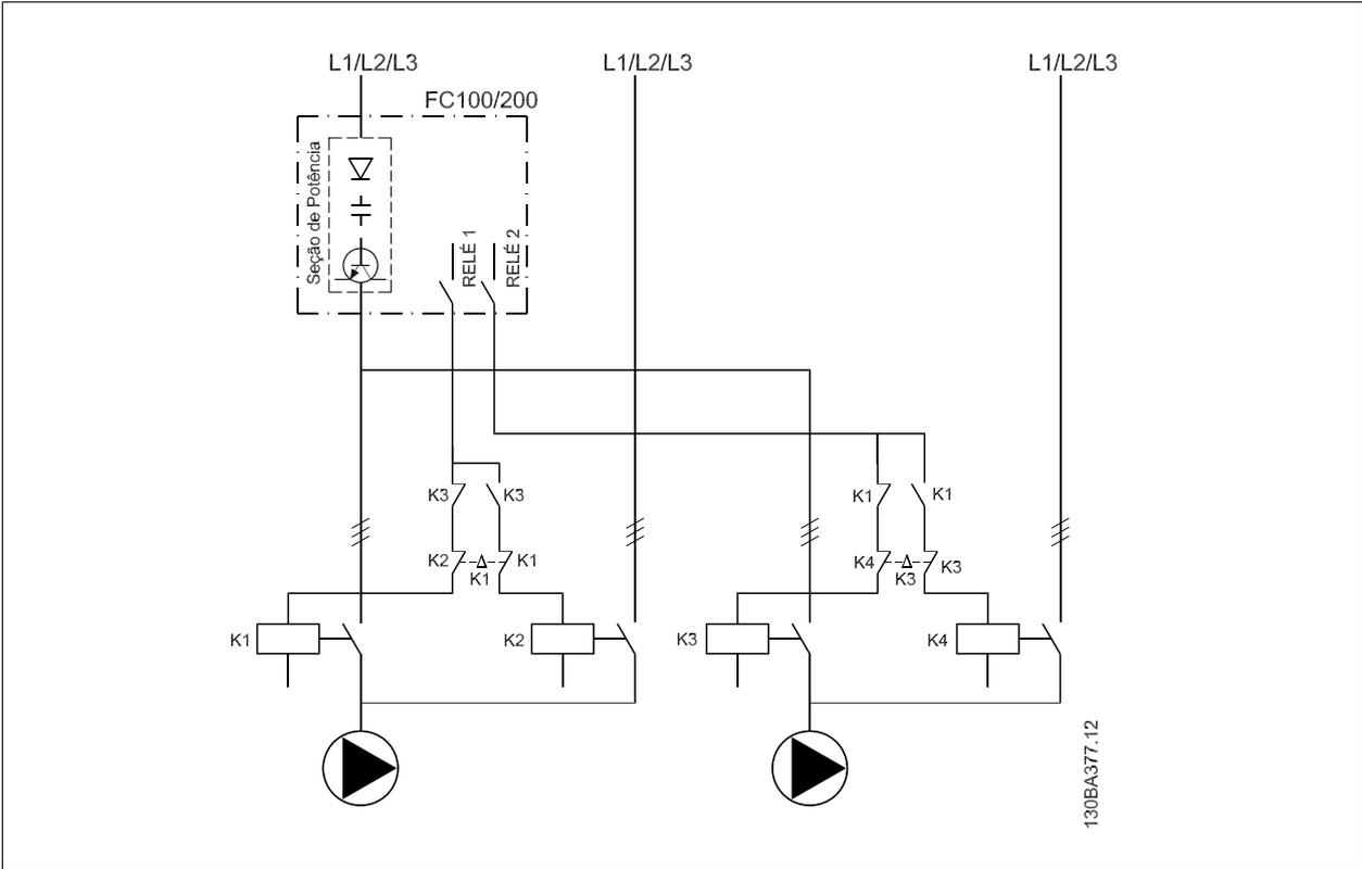
每台泵必须同两个带有机械互锁的接触器（K1/K2 和 K3/K4）相连。必须根据当地法规和/或单独要求采用热敏继电器或其他电动机保护装置。
