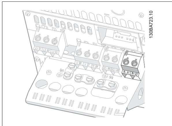
图 5.17: B4 的制动连接端子。
