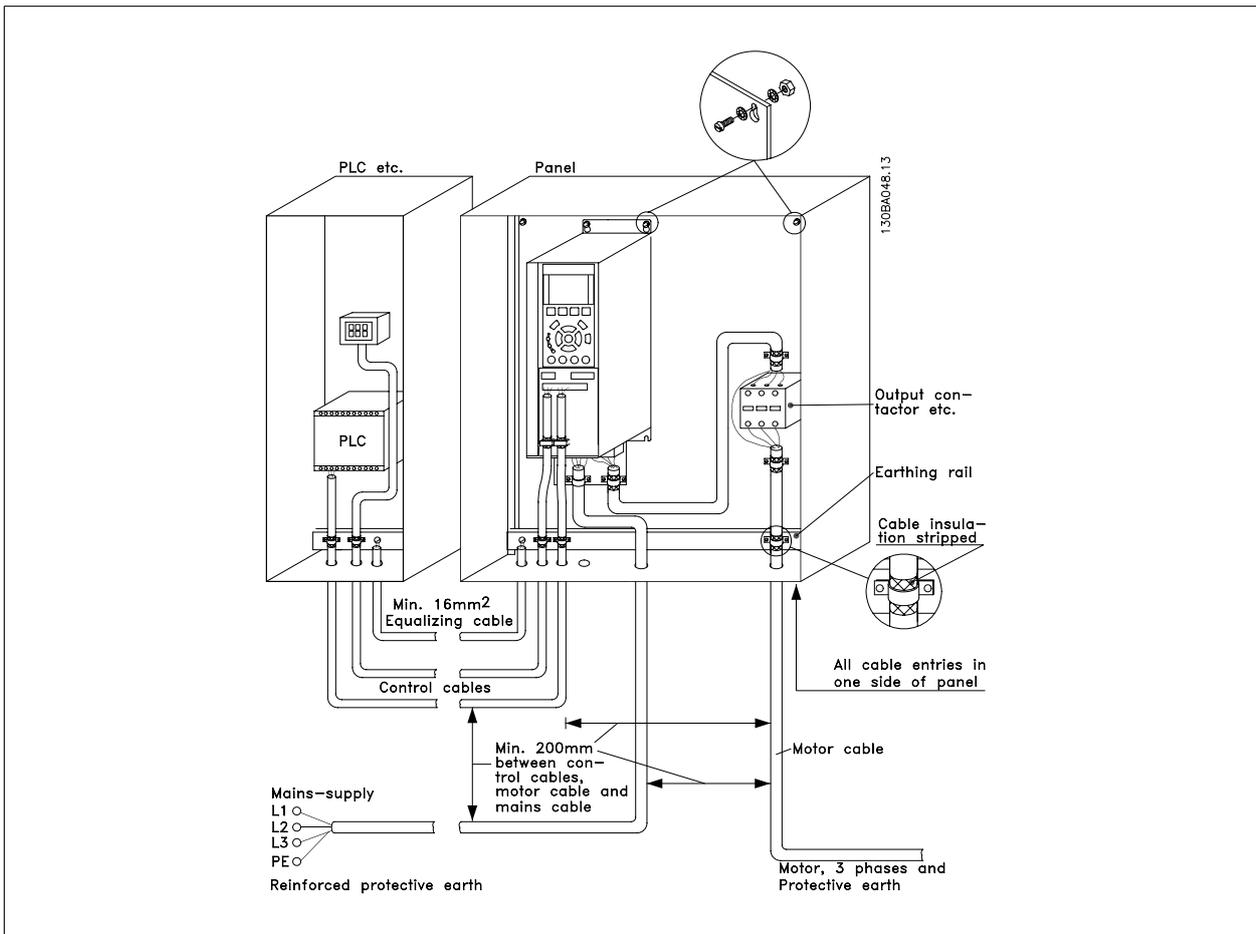
图 5.24: 在机柜中对变频器执行符合 EMC 规范的电气安装。
