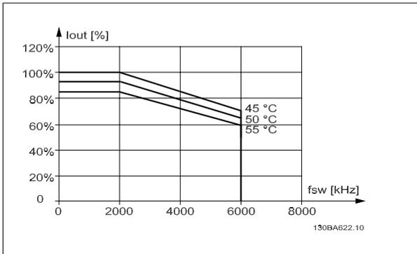
图 3.15: 480 V 时,  $I_{out}$  在不同  $T_{AMB, MAX}$  下的降容 - E 型机箱, 在正常转矩模式 (110% 过转矩) 下使用 60 AVM
