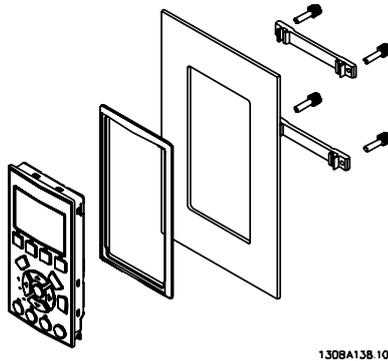
图 3.24: LCP 套件, 包括图形化 LCP、固定件、3 米长电缆和衬垫。
