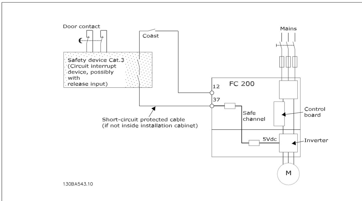
图 5.11: 符合安全类别 3 (EN 954-1) 停止类别 0 (EN 60204-1) 的安装基本配置的简图。
