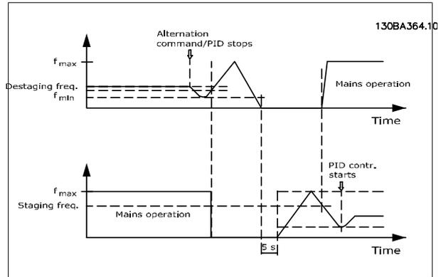
恒速泵的继电器在经过一个延迟后切入，此泵随即成为新的变频泵。新变频泵加速到最大速度，接着减速到最小速度。当减速至切入频率时，旧变频泵便会作为新的恒速泵切入到电网中。
