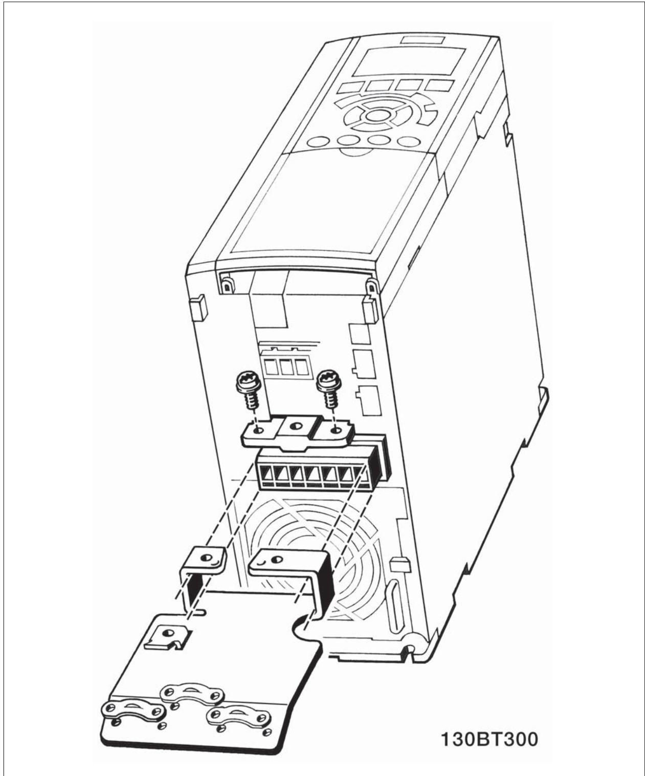
图 5.3: 安装去耦板。
