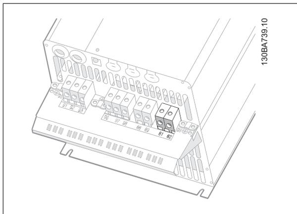
图 5.18: C3 的制动连接端子。
