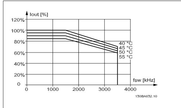
图 3.14: 600 V 时,  $I_{out}$  在不同  $T_{AMB, MAX}$  下的降容 - D 型机箱, 在正常转矩模式 (110% 过转矩) 下使用 SFAVM。注意: 仅限 P315。
