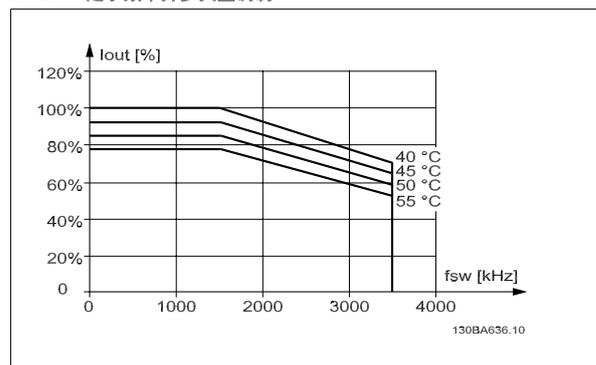
图 3.18: 600 V 时,  $I_{out}$  在不同  $T_{AMB, MAX}$  下的降容 - E 型机箱, 在正常转矩模式 (110% 过转矩) 下使用 SFAVM。
