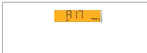
Рисунок 1.16: Пример отображения аварийного сигнала
