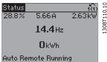
图 1.7: 步骤 1: 打开变频器 (On 指示灯亮起)
