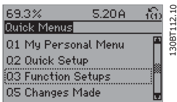
图 1.9: 步骤 3: 使用向上/向下导航键向下滚动到“功能设置”。按 [OK] (确定)。
