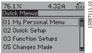
图 1.8: 步骤 2: 按 [Quick Menu] (快捷菜单) 按钮 (随即会显示快捷菜单选项)。
