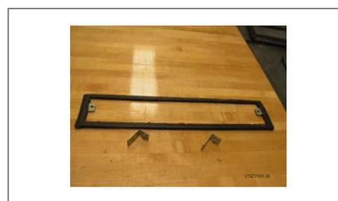
Disegno 3.32: Adattatore del condotto inferiore con guarnizione montata
