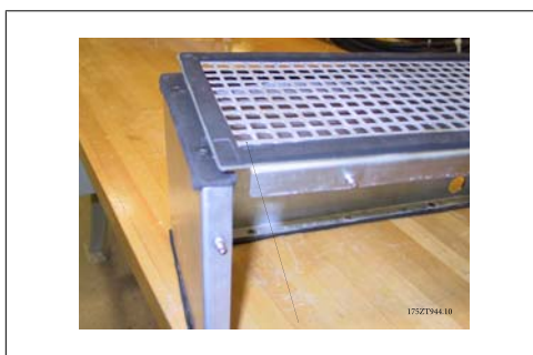
Bild 3.41: Packningen välvs över kanten så att en tätning bildas mellan kanalen och det övre ventilationsskyddet
