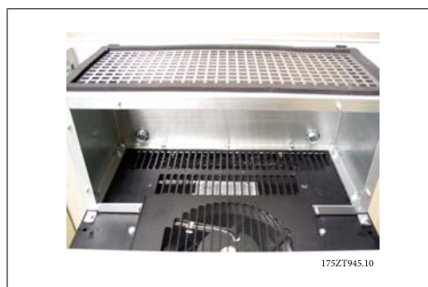
Bild 3.42: Övre kanal installerad
