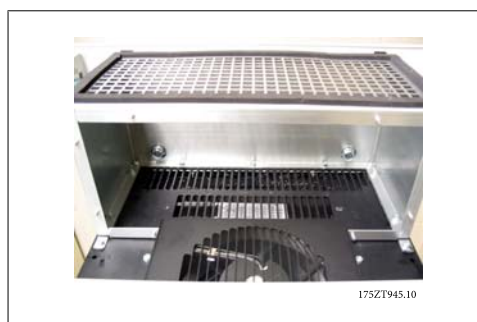
Kuva 3.42: Putkiston yläosa asennettu
