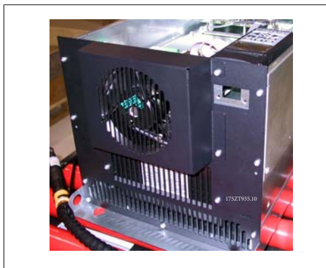
Kuva 3.35: IP 00 / runko -taajuusmuuttajan yläosa
