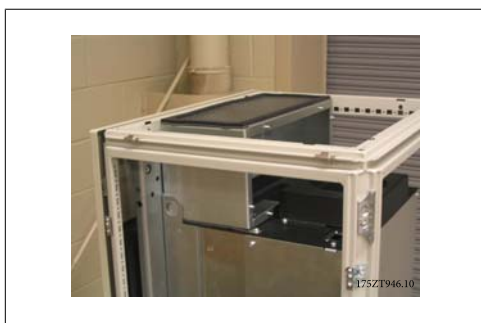
Ilustração 3.46: Duto superior instalado
