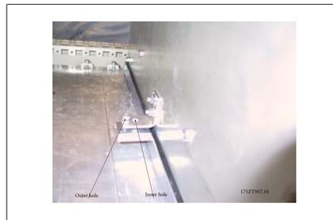
圖 3.58: 將安裝螺絲從外部孔移至內部孔
