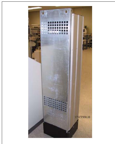
Ilustracja 3.30: Otwory w tylnej części nie wykorzystywane w tym zastosowaniu
