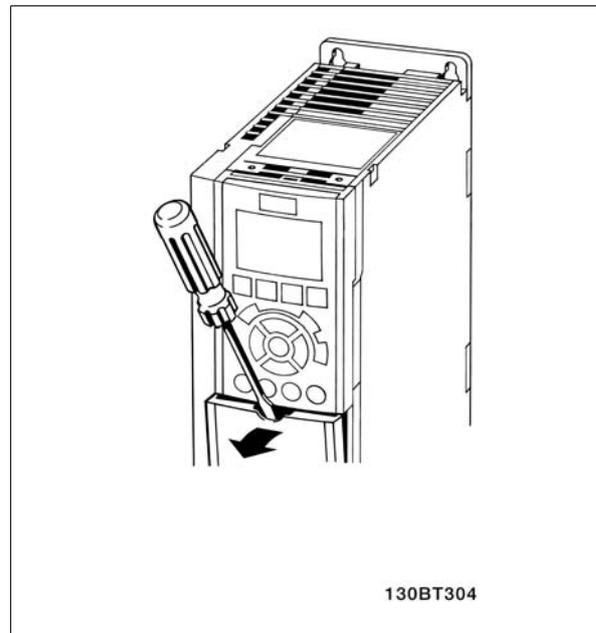
Abbildung 3.20: Zugriff auf Steuerklemmen in den Gehäusen A2, A3, B3, B4, C3 und C4.
