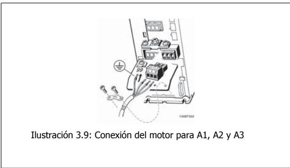
Ilustración 3.9: Conexión del motor para A1, A2 y A3
