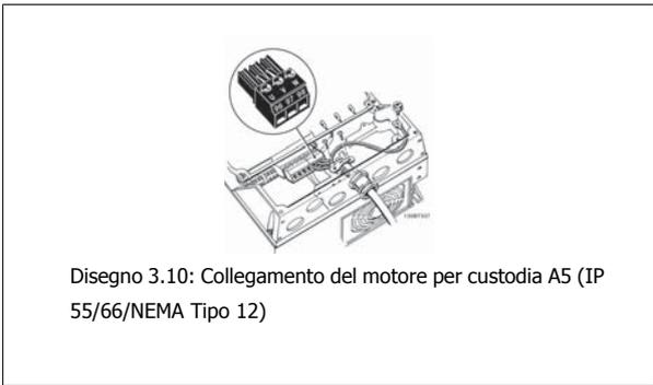
Disegno 3.10: Collegamento del motore per custodia A5 (IP 55/66/NEMA Tipo 12)
