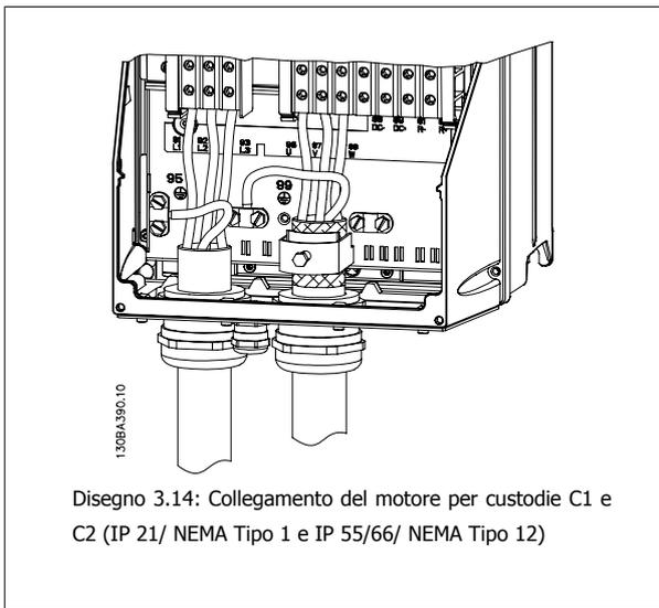
Disegno 3.14: Collegamento del motore per custodie C1 e C2 (IP 21/ NEMA Tipo 1 e IP 55/66/ NEMA Tipo 12)
