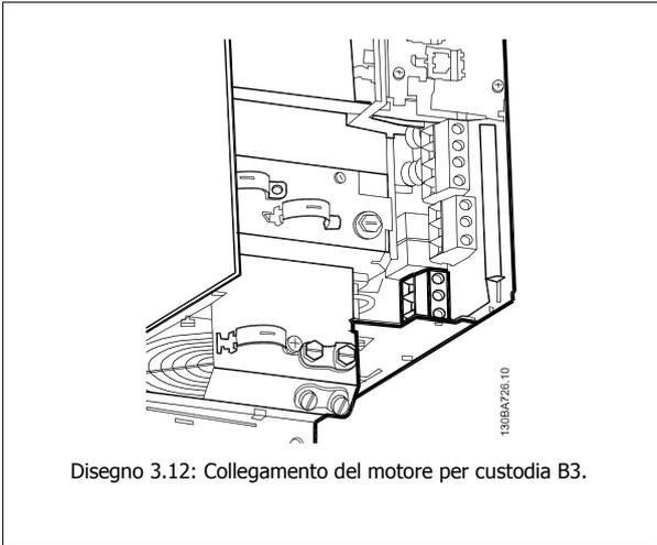
Disegno 3.12: Collegamento del motore per custodia B3.
