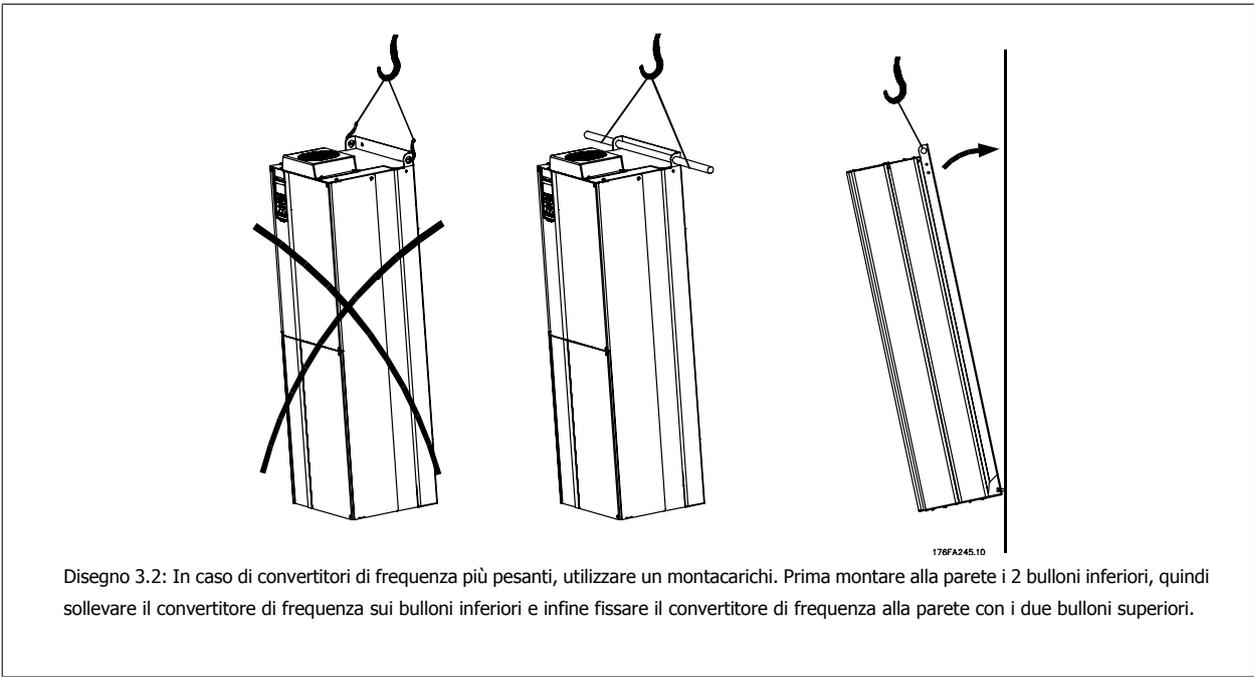
Disegno 3.2: In caso di convertitori di frequenza più pesanti, utilizzare un montacarichi. Prima montare alla parete i 2 bulloni inferiori, quindi sollevare il convertitore di frequenza sui bulloni inferiori e infine fissare il convertitore di frequenza alla parete con i due bulloni superiori.
