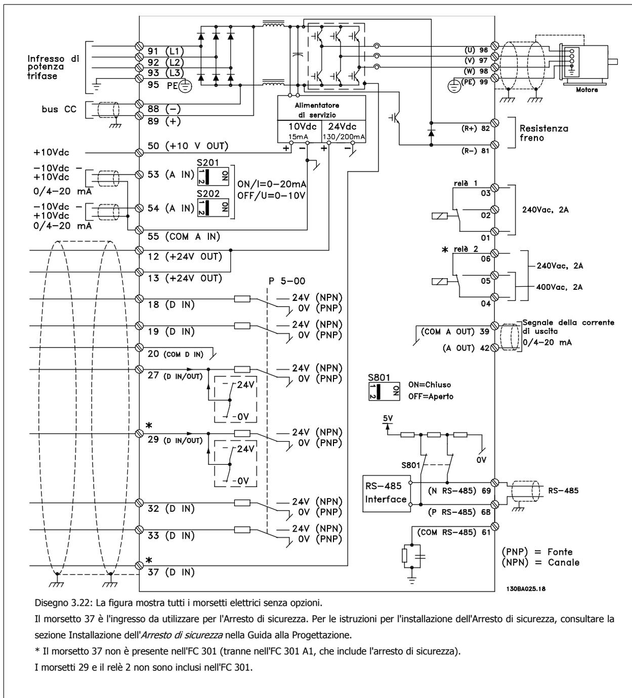
Con cavi di comando molto lunghi e segnali analogici, si possono verificare raramente e a seconda dell'installazione anelli di terra a 50/60 Hz, causati dai disturbi trasmessi dai cavi di rete.
