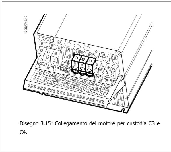
Disegno 3.15: Collegamento del motore per custodia C3 e C4.
