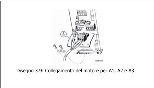
Disegno 3.9: Collegamento del motore per A1, A2 e A3
