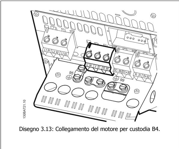
Disegno 3.13: Collegamento del motore per custodia B4.
