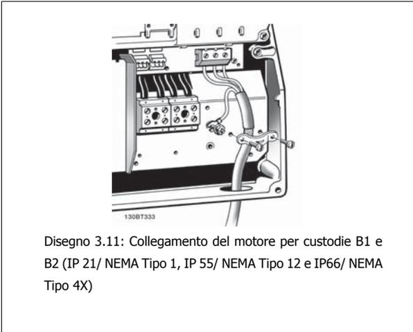
Disegno 3.11: Collegamento del motore per custodie B1 e B2 (IP 21/ NEMA Tipo 1, IP 55/ NEMA Tipo 12 e IP66/ NEMA Tipo 4X)
