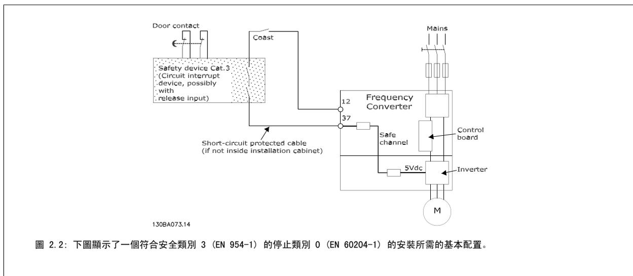
圖 2.2: 下圖顯示了一個符合安全類別 3 (EN 954-1) 的停止類別 0 (EN 60204-1) 的安裝所需的基本配置。
