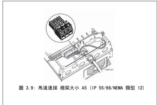
圖 3.9: 馬達連接 機架大小 A5 (IP 55/66/NEMA 類型 12)
