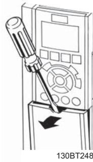
圖 3.19: A2、A3、B3、B4、C3 與 C4 外殼控制端子的操
