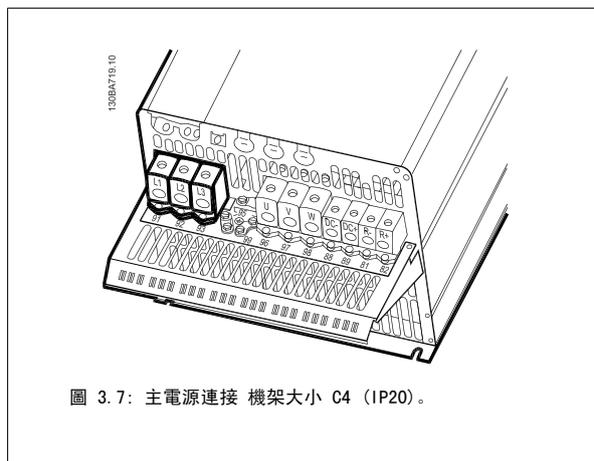
圖 3.7: 主電源連接 機架大小 C4 (IP20)。
