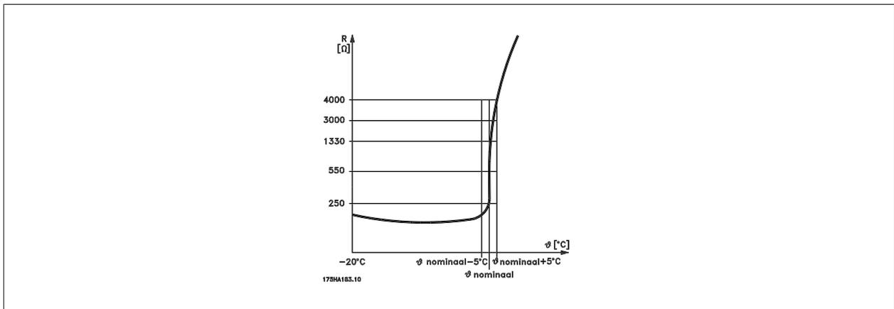
您可使用數種技術來執行馬達保護功能：馬達繞組中的 PTC 或 KTY 感測器（請亦參閱 *KTY 感測器連接* 一節）；機械式溫控開關（Klixon 類型）；或積熱電驛（ETR）。
