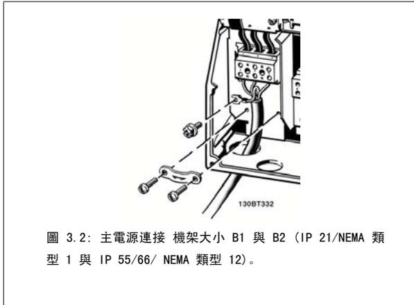
圖 3.2: 主電源連接 機架大小 B1 與 B2 (IP 21/NEMA 類型 1 與 IP 55/66/ NEMA 類型 12)。
