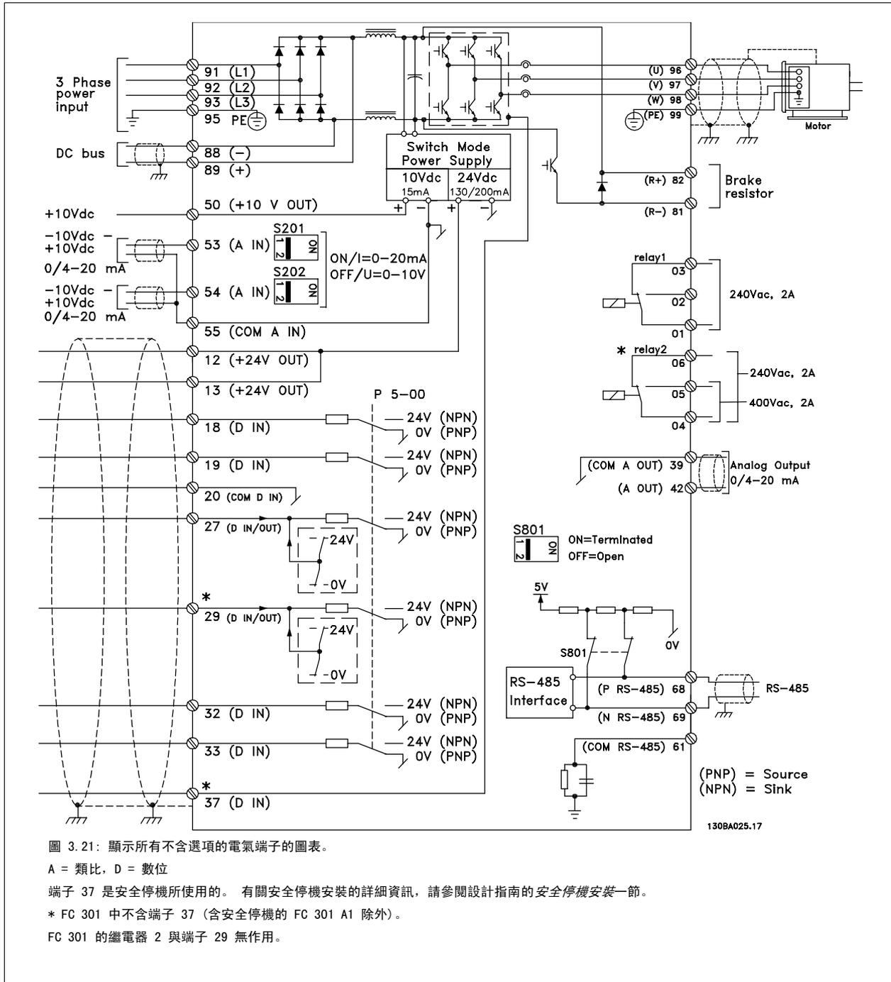
圖 3.21: 顯示所有不含選項的電氣端子的圖表。
