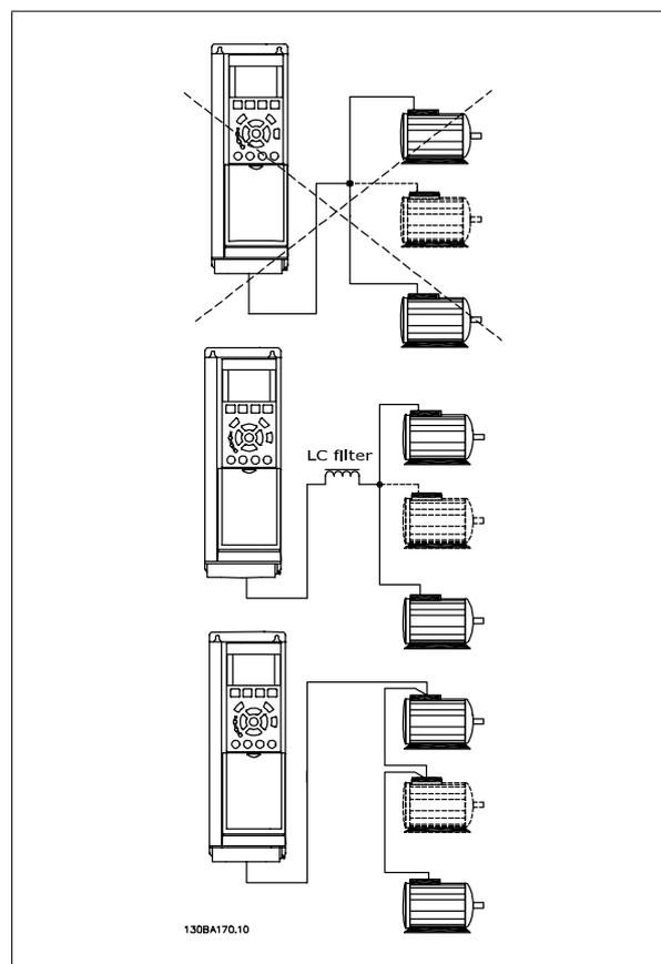
如果馬達大小有很大的差異，在啟動以及 RPM 值很低時可能會發生問題，因為小型馬達在定子中的電阻歐姆值相對較高，在啟動以及 RPM 值很低時需要較高的電壓。
