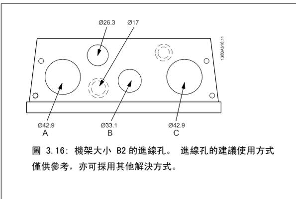
圖 3.16: 機架大小 B2 的進線孔。進線孔的建議使用方式僅供參考，亦可採用其他解決方式。
