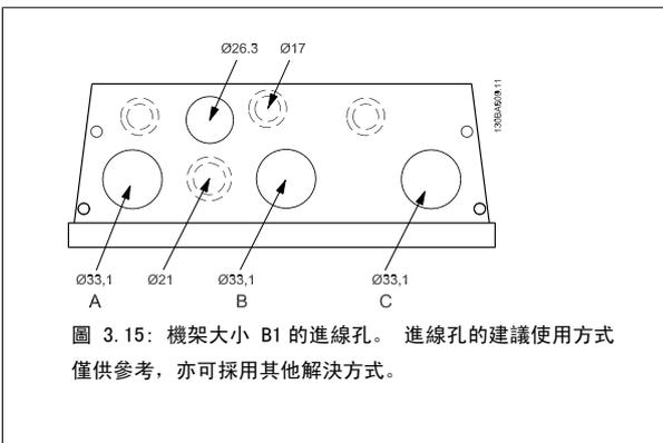
圖 3.15: 機架大小 B1 的進線孔。進線孔的建議使用方式僅供參考，亦可採用其他解決方式。
