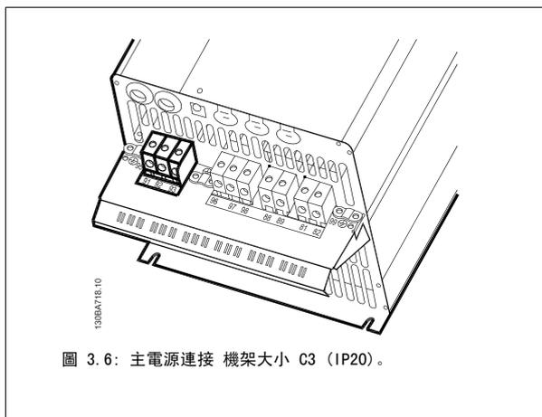
圖 3.6: 主電源連接 機架大小 C3 (IP20)。
