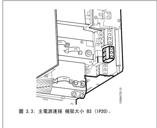
圖 3.3: 主電源連接 機架大小 B3 (IP20)。
