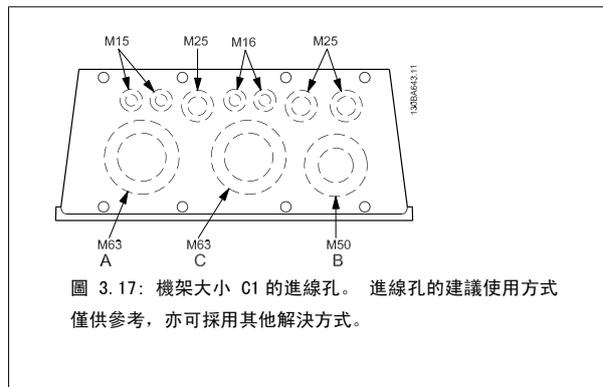
圖 3.17: 機架大小 C1 的進線孔。進線孔的建議使用方式僅供參考，亦可採用其他解決方式。
