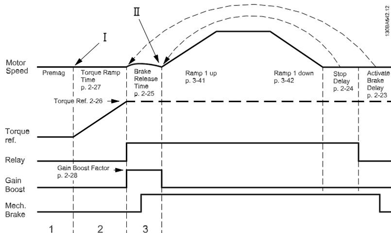
圖 4.1: 起重機械煞車控制的煞車釋放程序
