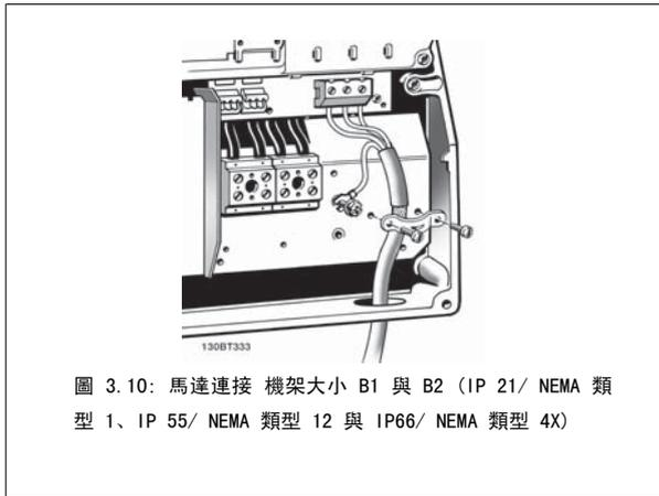
圖 3.10: 馬達連接 機架大小 B1 與 B2 (IP 21/ NEMA 類型 1、IP 55/ NEMA 類型 12 與 IP 66/ NEMA 類型 4X)
