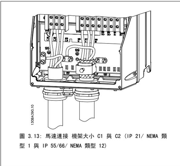
圖 3.13: 馬達連接 機架大小 C1 與 C2 (IP 21/ NEMA 類型 1 與 IP 55/66/ NEMA 類型 12)
