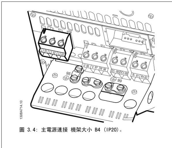
圖 3.4: 主電源連接 機架大小 B4 (IP20)。
