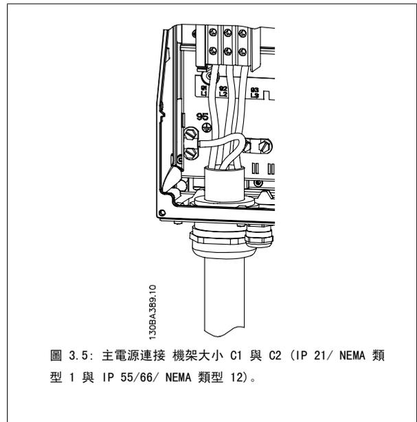
圖 3.5: 主電源連接 機架大小 C1 與 C2 (IP 21/ NEMA 類型 1 與 IP 55/66/ NEMA 類型 12)。
