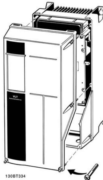
圖 3.20: A5、B1、B2、C1 與 C2 外殼控制端子的操
