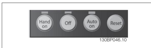
[[Hand on] (Marcha local) activa el control del convertidor de frecuencia a través del LCP. [Hand on] también pone en marcha el motor, y además ahora es posible introducir los datos de velocidad del mismo mediante las teclas de flecha. Esta tecla puede ajustarse a Activado [1] o Desactivado [0] mediante el parámetro 0-40 *Botón [Hand on] en LCP*.
