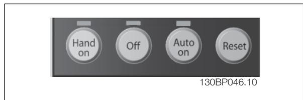
**[Hand on]** (Marcha local) activa el control del variador de frecuencia a través del LCP. **[Hand on]** también pone en marcha el motor, y además ahora es posible introducir los datos de velocidad del mismo mediante las teclas de flecha. Esta tecla puede configurarse en Activado [1] o Desactivado [0] mediante el par. 0-40 *Botón [Hand on] en el LCP*.
