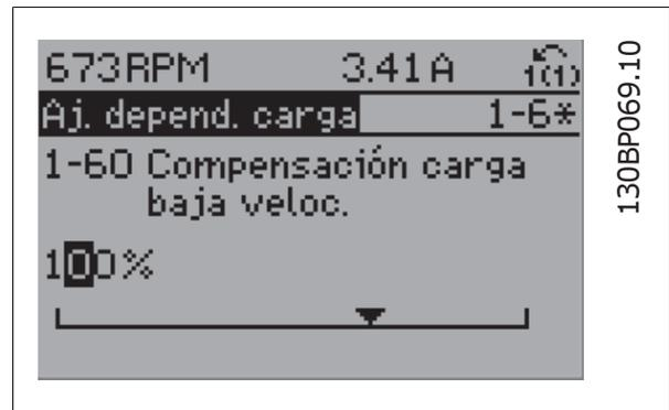
Utilice las teclas de navegación [▲] y [▼] para cambiar el valor de los datos. La tecla arriba aumenta el valor del dato y la tecla abajo lo reduce. Coloque el cursor sobre el valor que desea guardar y pulse [OK] (Aceptar).
