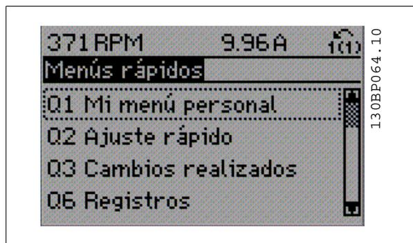
Seleccione *Configuración rápida* para ajustar una cantidad limitada de parámetros y conseguir que el motor funcione óptimamente. El ajuste predeterminado de los demás parámetros tiene en cuenta las funciones de control deseadas, además de la configuración de las señales de entrada/salida (terminales de control).
