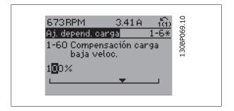
Utilice las teclas de navegación [▲] y [▼] para cambiar el valor de los datos. La tecla arriba aumenta el valor del dato y la tecla abajo lo reduce. Coloque el cursor sobre el valor que desea guardar y pulse [OK] (Aceptar).
