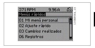
Seleccione *Configuración rápida* para ajustar una cantidad limitada de parámetros y conseguir que el motor funcione de forma casi óptima. El ajuste predeterminado de los demás parámetros tiene en cuenta las funciones de control deseadas, además de la configuración de las señales de entrada/salida (terminales de control).
