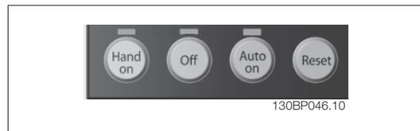
**[Hand On]** ermöglicht die Steuerung des Frequenzumrichters über das LCP. [Hand on] startet auch den Motor und ermöglicht die Änderung der Motordrehzahl mittels der Pfeiltasten. Die Taste kann aktiviert [1] oder deaktiviert [0] werden mit Par. 0-40 *[Hand On]-LCP Taste*.
