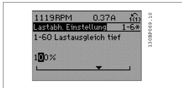
Mit den Navigationstasten [▲] [▼] einen Datenwert ändern. Die Taste nach oben erhöht den Datenwert, die Taste nach unten reduziert ihn. Stellen Sie den gewünschten Wert ein und drücken Sie [OK].
