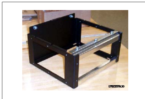
Abbildung 3.62: Teilweise montierter Sockel
