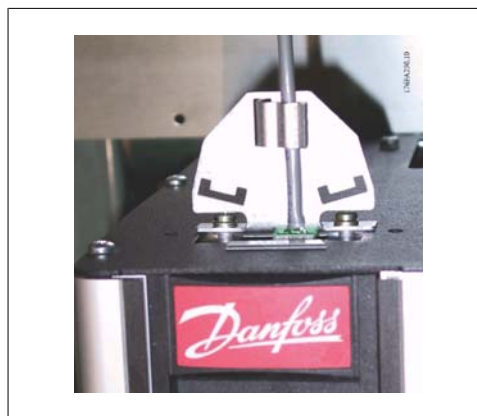
Abbildung 3.69: Anschluss von oben für Feldbus
