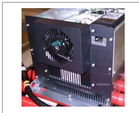
Abbildung 3.35: Oberseite des IP00/Chassis-Frequenzumrichters
