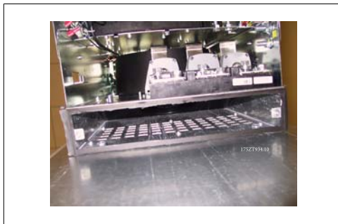
Disegno 3.33: Adattatore del condotto inferiore installato
