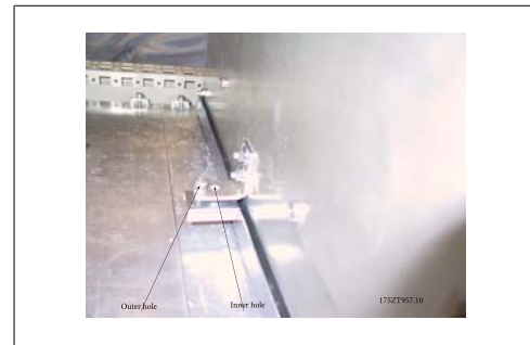
Kuva 3.58: Siirrä asennusruuvit ulommasta reiästä sisempään reikään
