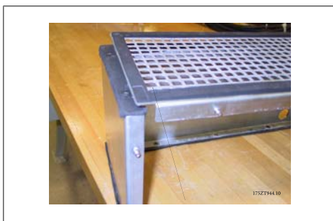
Kuva 3.41: Tiiviste taittuu reunan yli muodostaakseen tiivisteen putken ja yläosan tuuletetun suojuksen välille
