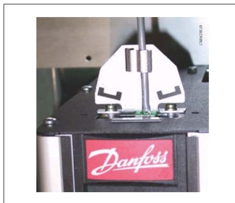
Ilustração 3.69: Conexão superior do fieldbus.
